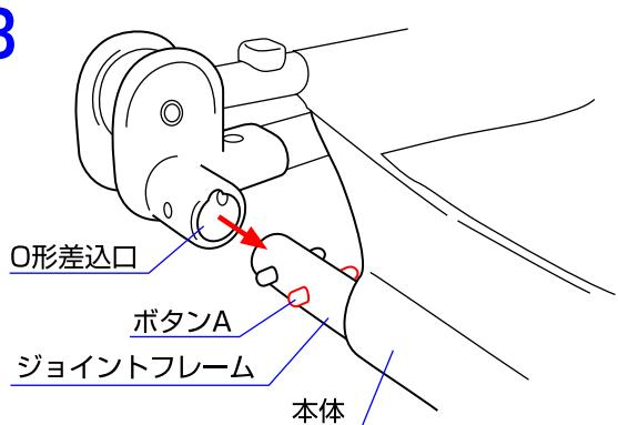
3.ジョイントフレーム先端のボタンAを押してO形差込口から外し、ジョイントフレームを本体から抜き取って下さい。
