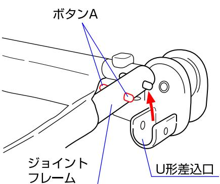
2.ジョイントフレーム先端のボタンAを押してU形差込口から外して下さい。
