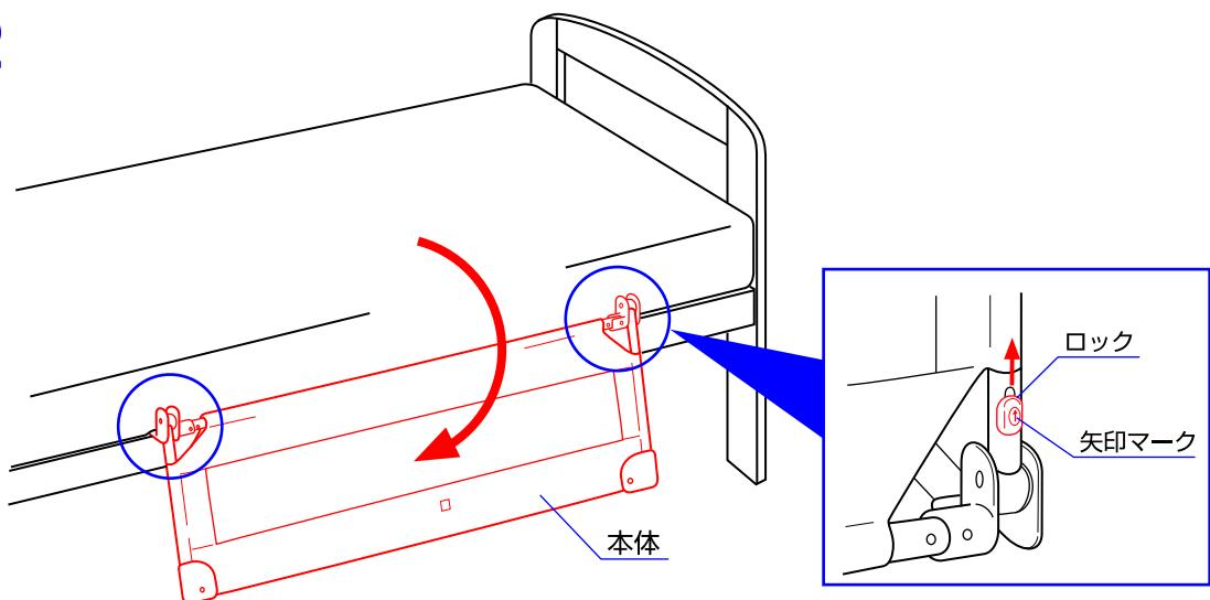
2.使用しない時は本体両側の下側に付いているロックを矢印マークの方向に外し、本体を手前に倒して下さい。
