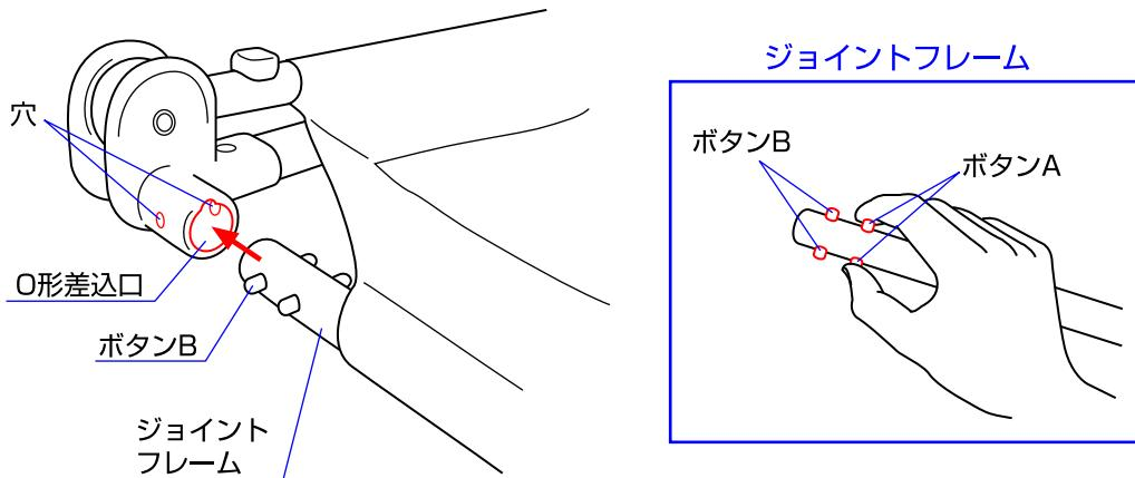
5. ジョイントフレームはボタンAを押すと、同時にボタンBも引っ込みますので、最初にO形差込口にボタンAを押しながらジョイントフレームを差し込み、ボタンBを穴から出して下さい。
