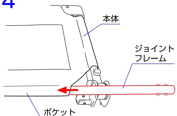
3.ジョイントフレームBのジョイントボタンを押さえながら、ジョイントフレームAに差し込んで下さい。
