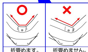
4. ①本体上部を少し持ち上げて下さい。②ラッチマーク部分を押してラッチを外して下さい。
