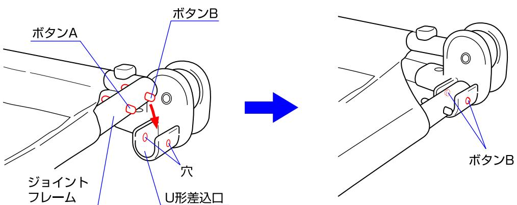
6. ジョイントフレーム反対側の先端をU形差込口に差し込んで下さい。「組立方法5」と同様にボタンAを押しながら差し込み、ボタンBを穴から出して下さい。
