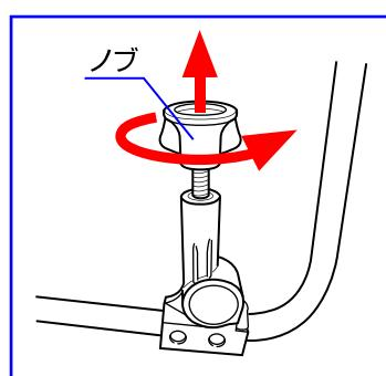
3.ロックバーを起こし、ノブを矢印方向に回して締め込み、ロックバーをテーブルにしっかりと固定して下さい。
