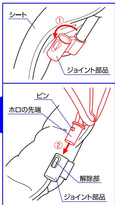
1. ①ジョイント部品をシートから出して下さい。②ホッドを本体の背もたれにかぶせ、両側にあるホッドの先端のピンを押さえながら、本体両側に付いているジョイント部品に差し込んで下さい。ホッドのクリップを下げるで固定して下さい。※ホッドの先端のピンがジョイント部品の解除部から出ていることを必ず確認して下さい。
