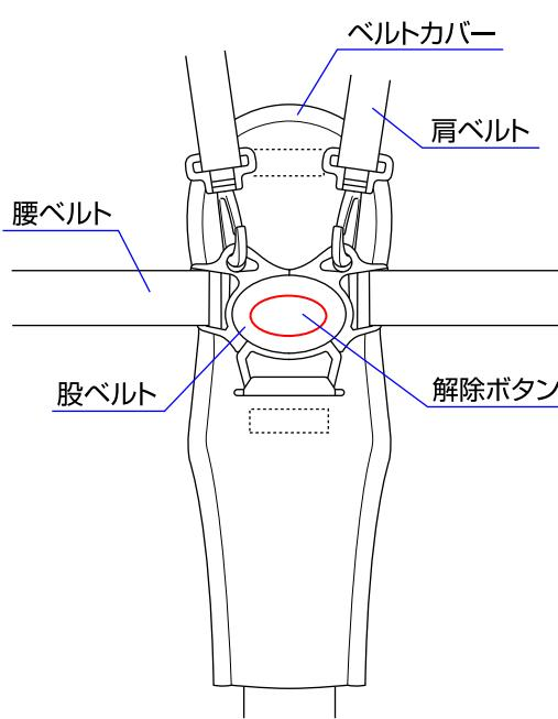
◇ベルトカバーを開け、肩ベルトを腰ベルトに取り付け、股ベルトに差し込んで下さい。ベルトカバーを股ベルトに付ける時は図のように取り付けて下さい。
