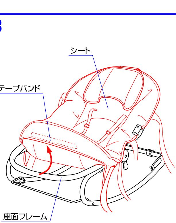
2. 背もたれと座面の裏側に付いているベルトを外して下さい。
