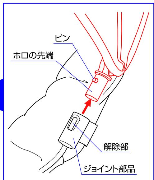
1.ホロとトイバーを取り外して下さい。ホロはジョイント部品の解除部を押して、ホロの先端を取り外して下さい。
