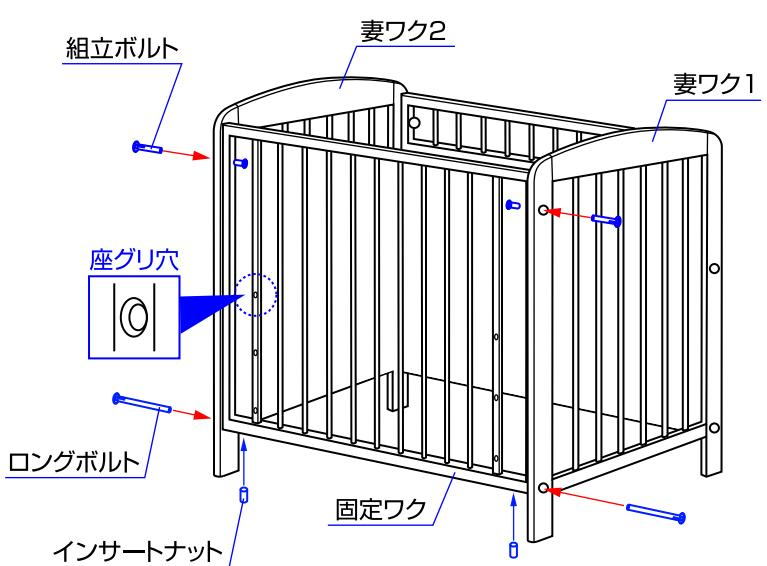
3. 固定ワクと妻ワク1、2を同じように固定して下さい。※固定ワクは座グリ穴のある方を外側にして下さい。
