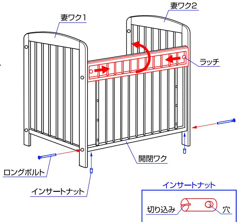
2. 閉閉ワクの下側からインサートナットを差し込み、ロングボルトで固定して下さい。
