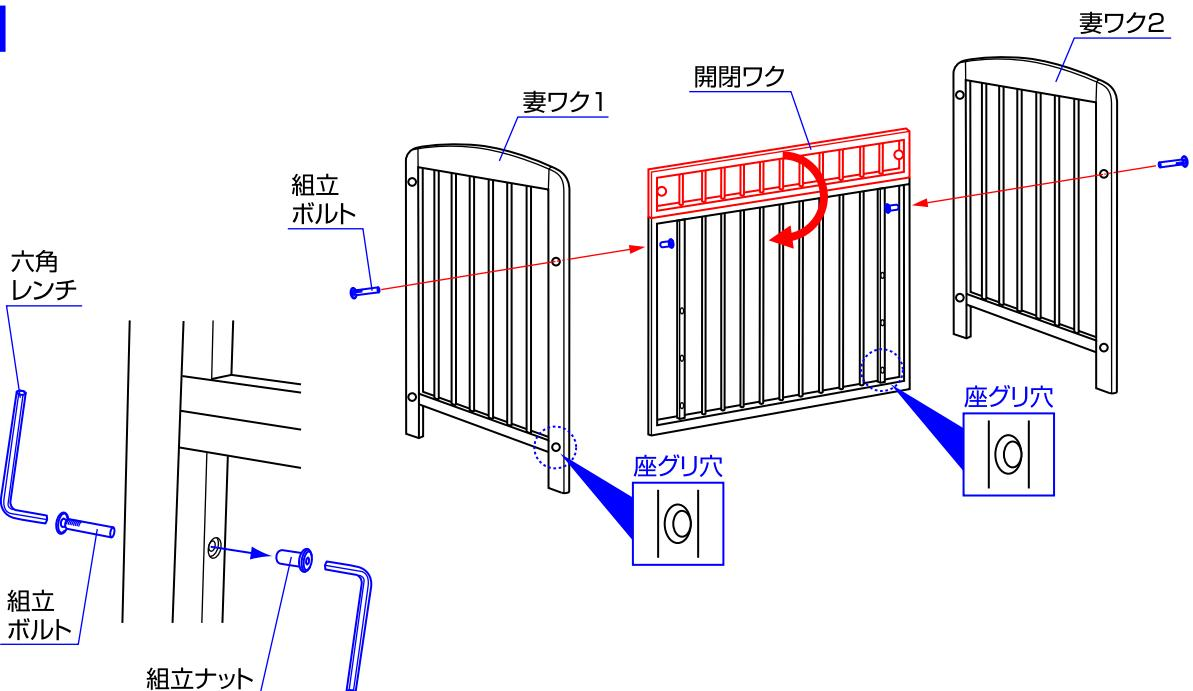
1.開閉ワクの上部を矢印方向に開いた状態で、開閉ワクを妻ワク1と2に組立ボルトと組立ナットで固定して下さい。(組立ボルトと組立ナットは先に外して下さい。ボルトとナットは六角レンチで締めて下さい。)
