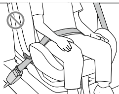
シート肩ベルトが反対側（シートベルトの取り出し口側）の腰ベルトパスにも通っている
