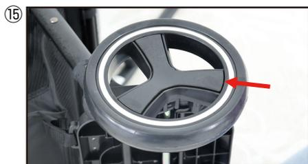
・ マイナスドライバーを布で巻き、カバーの隙間(矢印部分)に差し込み、カバーを取り外してください。
