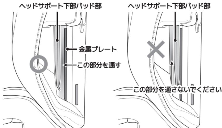
シートタングは、シートバック内側の金属プレートの上を通るようにしてください。ヘッドサポートの高さを調節をするとヘッドサポート下部のパッド部も上下に動きますので、ヘッドサポート下部のパッド部の上をシートタング（シートベルト）が通るとシートベルトがヘッドサポートを押さえつけてしまい、本製品が正しく機能しないおそれがあります。
