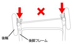
●後輪を片側ずつ後脚フレームに差し込んで取り付けようと すると、後輪が破損する恐れがあります。
