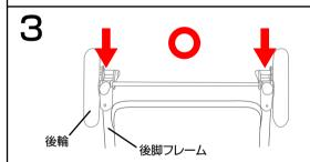
●後輪の左右を同時に後脚フレームに差し込み、ゆっくりと 取り付けを行ってください。
