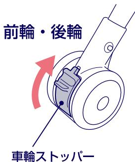
ラックを移動する時は、車輪ストッパーを矢印の方向に下げてロックを解除します。左右の前輪、後輪とも行ってください。
