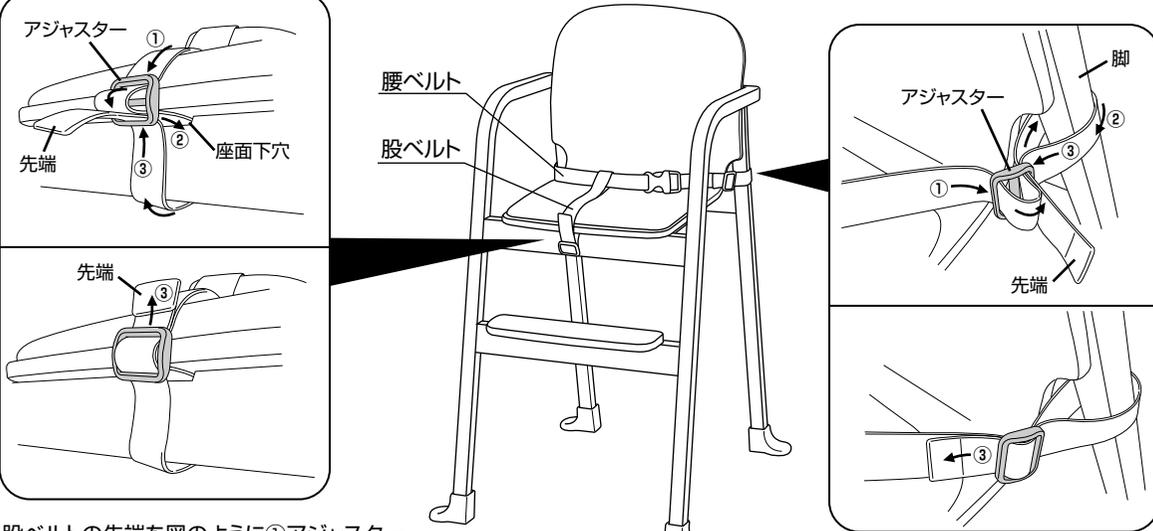
・股ベルトの先端を図のように①アジャスターに通してから、②座面下穴に通し、③再度アジャスターに通して固定してください。
