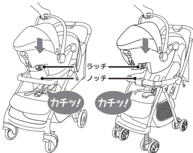
本製品を軽く動かして、ラッチがセイフティガードのノッチに噛みこんでいるか確認します。
