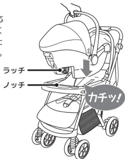
本製品を軽く動かして、ラッチがトレイのノッチに噛みこんでいるか確認します。この時点では、ラッチ部分のみでの固定ですので、本製品はまだ完全には固定されていません。軽く動かすだけにしてください。
