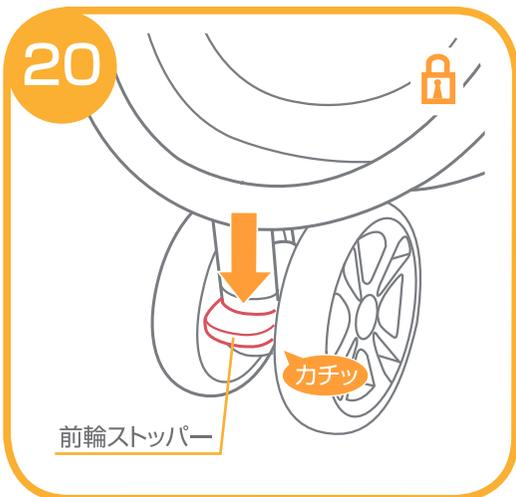
20.前輪ストッパーを下げると、前輪の進行方向が固定されます。前輪ストッパーを上げると前輪が360°キャスト回転します。
