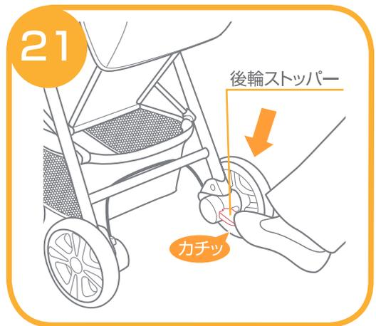
21.片側の後輪に付いている後輪のストッパーを下げると後輪がロックします。後輪ストッパーを上げると解除します。※お子様を乗り降りさせる場合には、必ず後輪ストッパーをロックして下さい。
