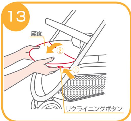
13.座面を下げる場合は、①座面の両側に付いているリクライニングボタンを押して、②座面を下げて下さい。座面を上げる場合は座面を持って上げて下さい。
