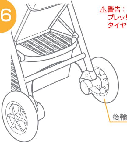
△警告：サイクルショップやガソリンスタンドなどに設置されているエアコンプレッサー(電動空気入れ機)は使用しないでください。過度に空気が入り、タイヤが破裂したり重傷を負ったりする可能性があります。
