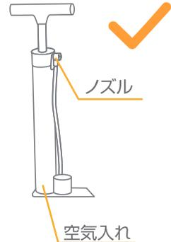
26.後輪に空気を入れる場合は、後輪に付いているキャップを回して外して下さい。英式バルブ対応のノズルの付いた空気入れで空気を入れて下さい。空気を入れた後は必ずキャップを付けて下さい。※空気は入れすぎないように、タイヤを指で押して1cmほど凹むくらいにして下さい。※ベビーカーを使用する前に、タイヤの空気圧を確認して下さい。空気圧は、側面に記載されている最大推奨膨張圧力値を超えてはなりません。空気圧の値を超えると、タイヤが破裂したり、重傷を負ったりする可能性があります。
