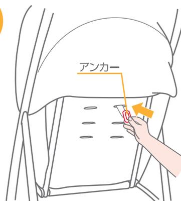
17.肩ベルトの高さを変える場合は、アンカーを図の向きにしながら、背もたれ後部から表側に取り外して下さい。
