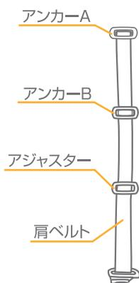
16.大きなお子様には、肩ベルトのアンカー-Aを一番上の肩ベルト穴に通して背もたれの後部から出して下さい。小さなお子様には、肩ベルトのアンカー-Bを一番下の肩ベルト穴に通して背もたれの後部から出して下さい。
