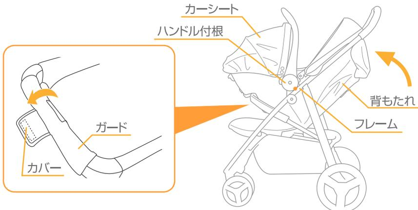
27.ガードに付いているカバーは、別売りのカーシートを取り付ける場合に開けて下さい。カーシートを取り付けた後、背もたれを上げて下さい。その時にカーシートのハンドル付け根部分が、ベビーカーのフレームに接地していることを必ず確認して下さい。また、ハンドル付け根部分がフレームの内側に入り込んでしまう場合がございますので、ハンドル付け根部分がフレームの上にくるように調節して下さい。
