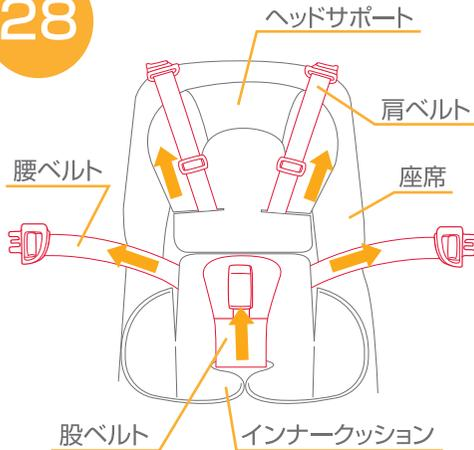
28.ヘッドサポート、インナークッションを取り付ける場合は、図のように座席に置き、シートベルトを出して下さい。ヘッドサポートはボタンで固定して下さい。
