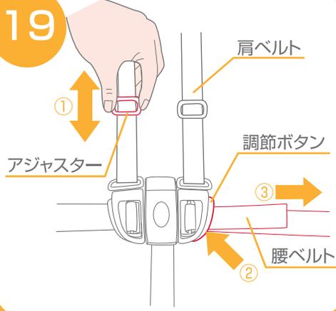
19.①肩ベルトの長さを調節する時はアジャスターで調節して下さい。腰ベルトの長さを調節する時は②調節ボタンを押しながら、③腰ベルトを引っ張り調節して下さい。
