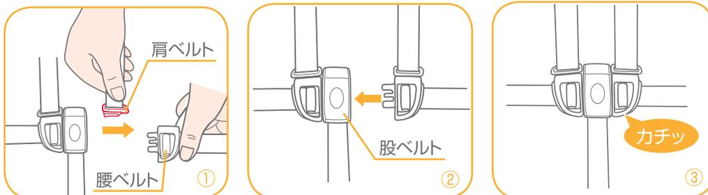
15.シートベルトを取り付ける場合は、①肩ベルトを腰ベルトに通し、②股ベルトに差し込んで下さい。
