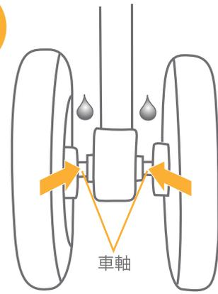
25.前輪・後輪の車輪の動きが悪い場合は、油等を車軸に注して下さい。
