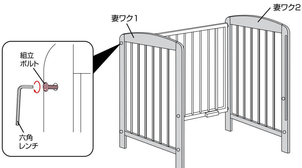
・図1で**仮止め**した妻ワク1と2の組立ボルトとナットを六角レンチで**確実に締め付けて**ください。
