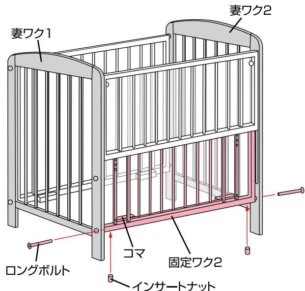
①固定ワク2の裏側からインサートナットを差し込み、妻ワク1、2の方向からロングボルトで固定してください。インサートナットは切り込みを手前にして、穴をボルト方向へ向けてください。
