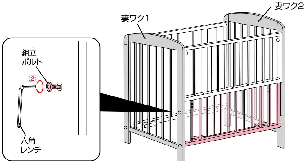
②図5で仮止めした妻ワク1と2の組立ボルトとナットを六角レンチで確実に締め付けてください。
