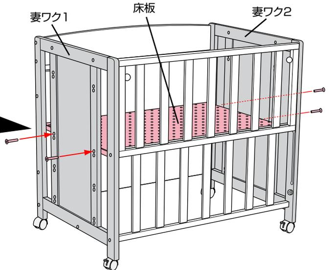
・妻ワク1、2に組立ボルトSで床板に4箇所指で回しスムーズに回りましたら、全ての組立ボルトSを六角レンチで**確実に締め付けて**ください。
