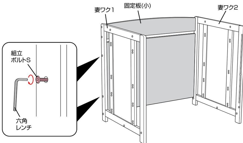
・図1で**反止め**した妻ワク1と2の組立ボルトSを六角レンチで**4箇所確実に締め付けて**ください。
