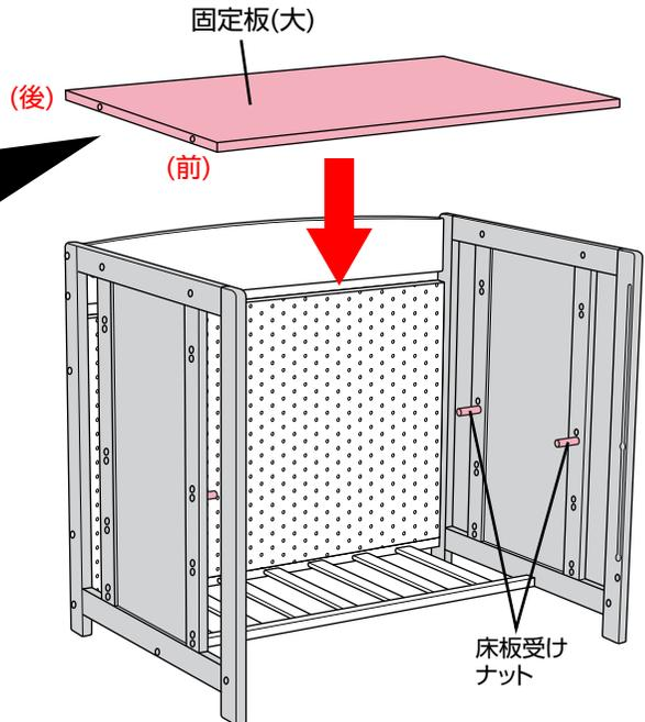
・固定板(大)の向きに注意して、固定板(大)を床板受けナットに載せてください。
