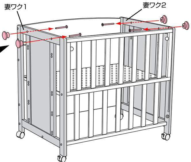
・妻ワク1、2に取手を取手用ボルトで取り付けてください。取手用ボルトはプラスドライバーで締め付けてください。
