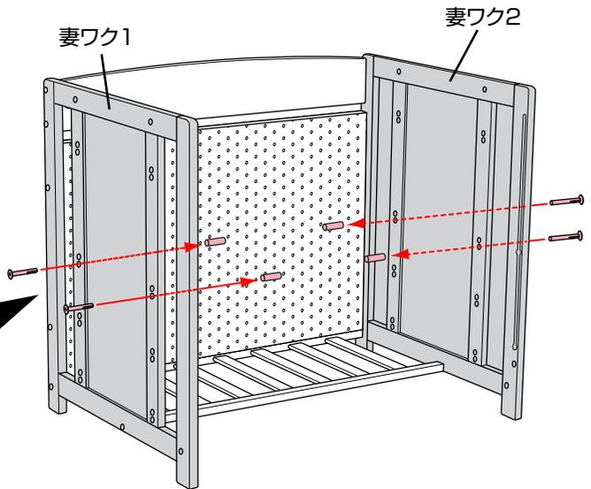
・床板受けボルトと床板受けナットを妻ワク1、2に取り付けてください。
