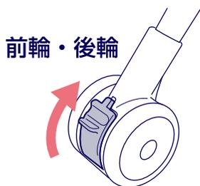
ラックを移動する時は、車輪ストッパーを矢印方向に下げてロックを解除します。左右の前輪、後輪とも行って下さい。
