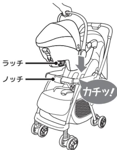
本製品を軽く動かして、ラッチがセイフティガードのノッチに噛みこんでいるか確認します。
