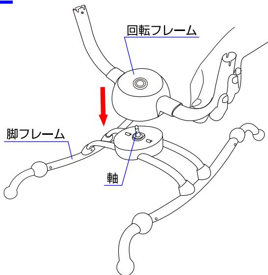
1. ロック部品を脚フレームに差し込んで取り付けて下さい。
