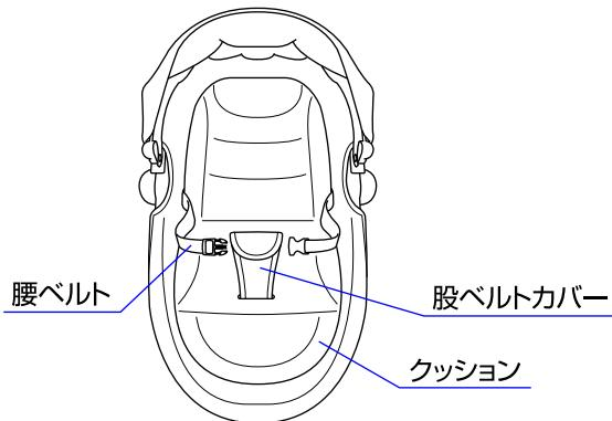
◇股ベルトカバーをクッションの穴に通し、腰ベルトを股ベルトカバーに通して取り付けて下さい。取り外す場合は逆の手順で行って下さい。
