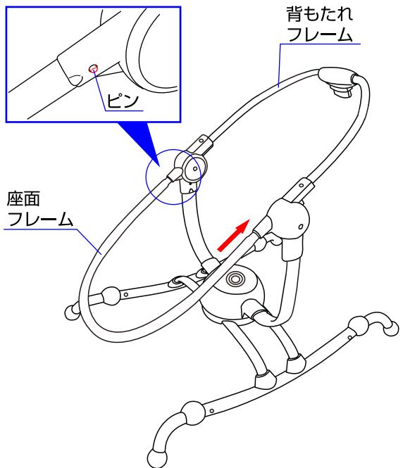
3. 背もたれフレームの両側を回転フレームに差し込んで取り付けて下さい。※回転フレームのピンが背もたれフレームの穴から出ていることを必ず確認して下さい。
