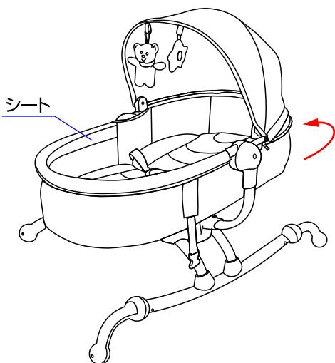
◇シートを起こし、ロック部品を回転させ、座席の裏側にある固定バックルを取り付けて下さい。
