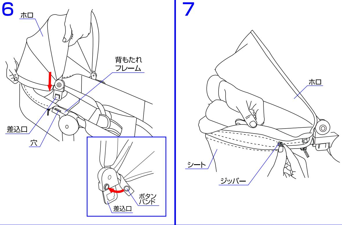
6.ホロの両側にある差入口の内側にホロのボタンバンドを取り付けて下さい。ホロの両側にある差入口を背もたれフレームの穴に差し込んで固定して下さい。
