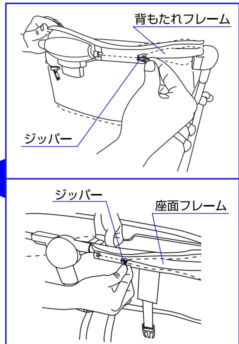
5. シートを背もたれフレーム、座面フレームにかぶせて下さい。シートを背もたれフレーム、座面フレームに固定する場合は、ジッパーを閉めて固定して下さい。シートの背もたれ側のジッパーはシートの両側に付いています。
