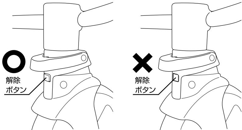
①前輪を取り付けた際に解除ボタンが確実に出ていることを確認してください。
