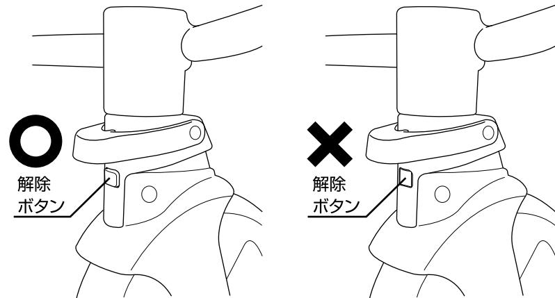
①前輪を取り付けた際に解除ボタンが確実に出していることを確認してください。
