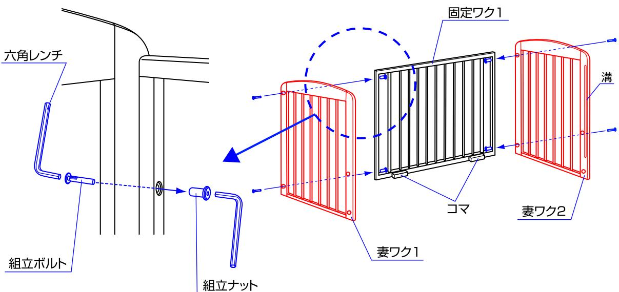
1.妻ワク1と2を固定ワク1に組立ボルトと組立ナットで固定してください。
