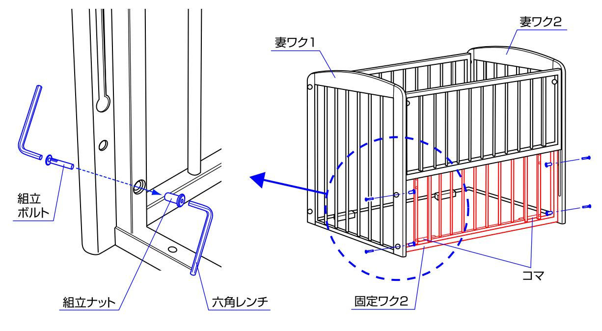
3.妻ワク1と2に固定ワク2を組立ボルトと組立ナットで固定してください。
