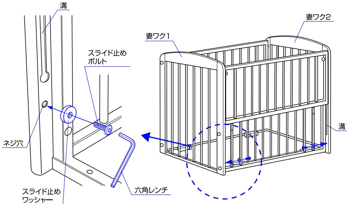
4.妻ワク1と2の溝の下のネジ穴にスライド止めワッシャーをスライド止めボルトで固定してください。
