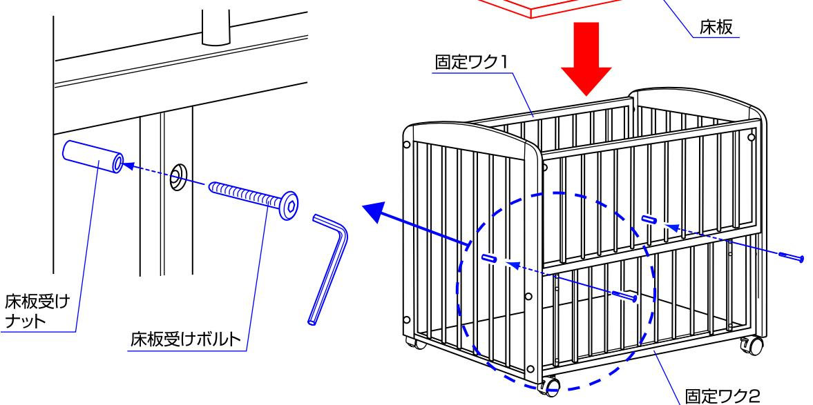
7.床板受けボルトと床板受けナットを固定ワク1、2に取り付けてください。 (3段階調節)
