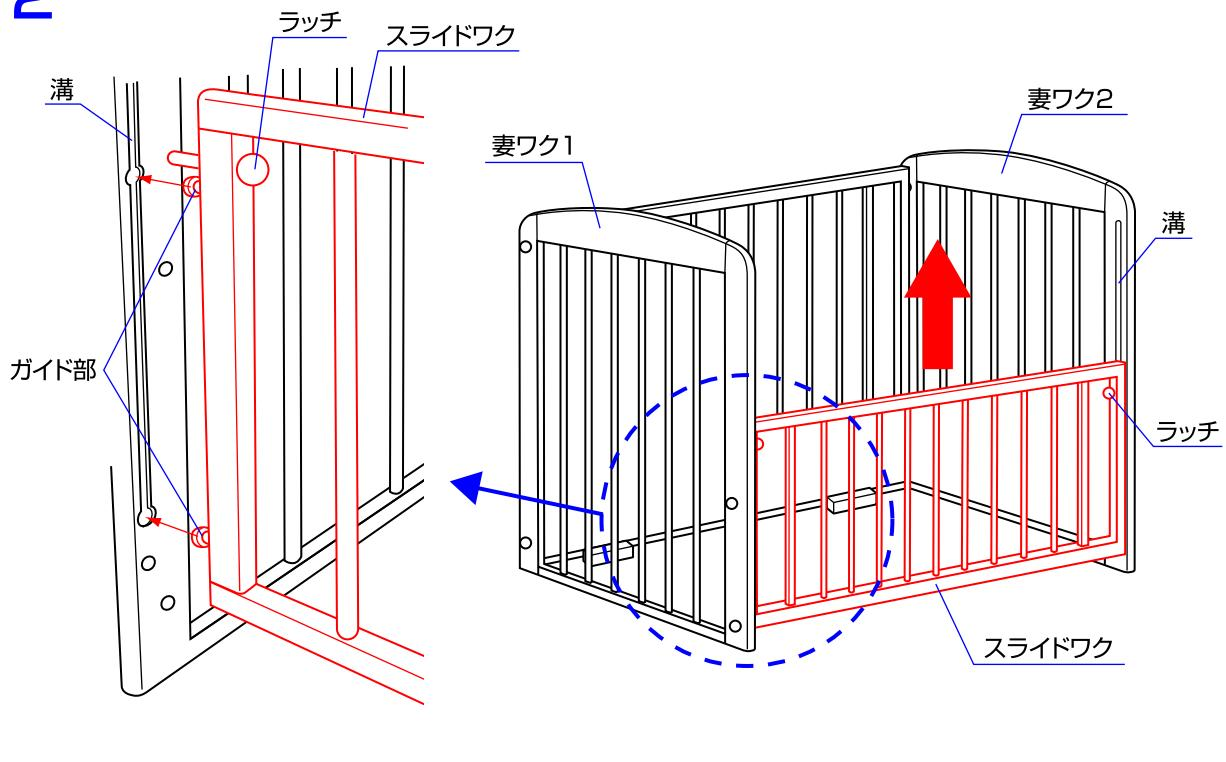
2.スライドワクのガイド部を図のように妻ワク1と2の溝の丸い部分に差し込み、スライドワクを上にスライドさせてください。
