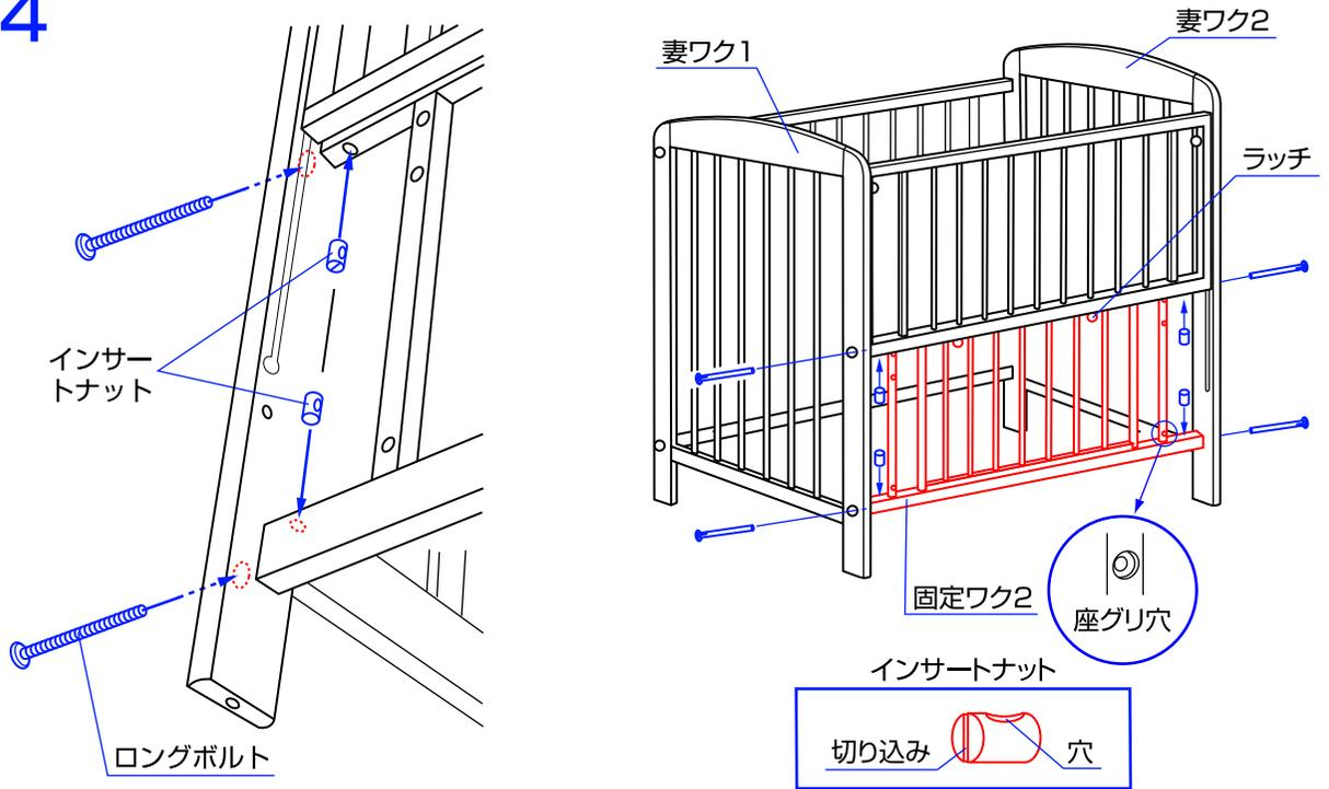
4. 固定ワク2の穴にインサートナットを差し込み、妻ワク1と2の方向からロングボルトで固定してください。
