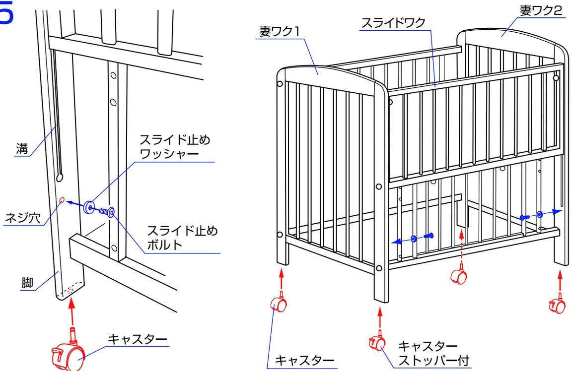
5. 妻ワク1と2の溝の下のネジ穴にスライド止めワッシャーをスライド止めボルトで固定してください。妻ワク1と2の脚の裏側にカスターを図のように差し込んでください。カスターはストッパーのある方をスライドワク側に差し込んでください。※ベッドの移動時以外は必ずカスターのストッパーを上げてロックしてください。
