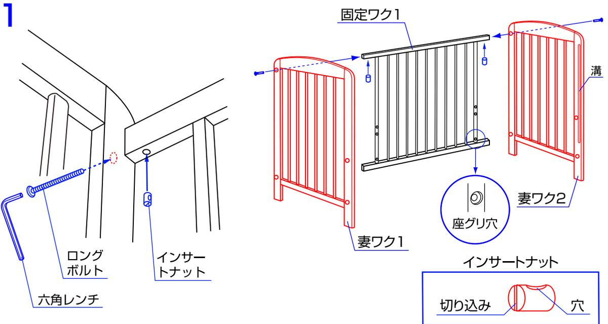
1. 固定ワク1の裏側からインサートナットを差し込み、妻ワク1、2の方向からロングボルトで固定してください。
