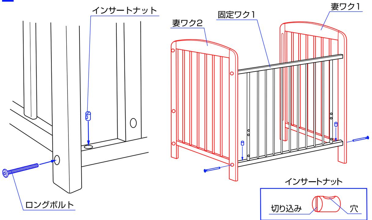
2. 固定ワク1にインサートナットを差し込み、妻ワク1、2の方向からロングボルトで固定してください。
