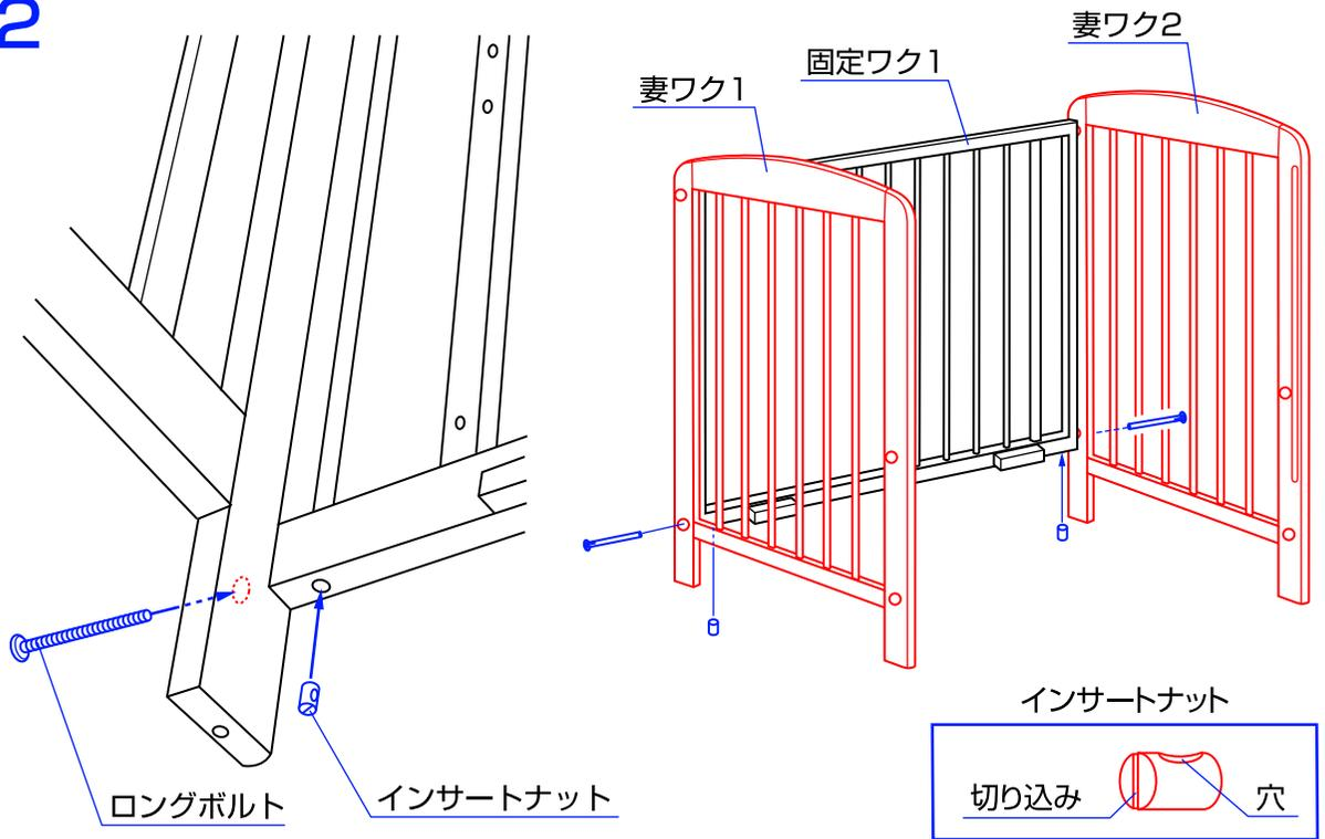
2.固定ワク1の裏側からインサートナットを差し込み、妻ワク1、2の方向からロングボルトで固定してください。※インサートナットは切り込みを下に向けて穴をボルト方向へ向けてください。
