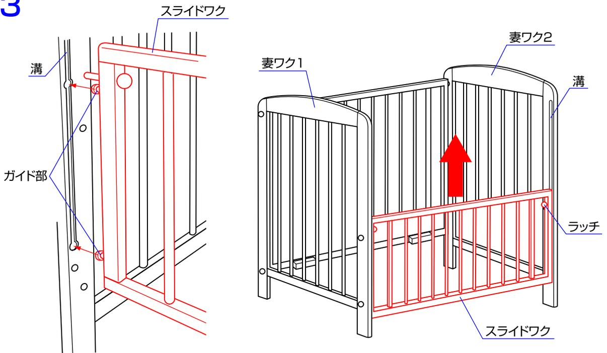
3.スライドワクのガイド部を図のように妻ワク1と2の溝の丸い部分に差し込み、スライドワクを上へスライドさせてください。※スライドワクを開閉する時に手足等をはさむ危険性がありますから十分に注意してご使用ください。また、保護者の方以外は絶対に操作しないでください。
