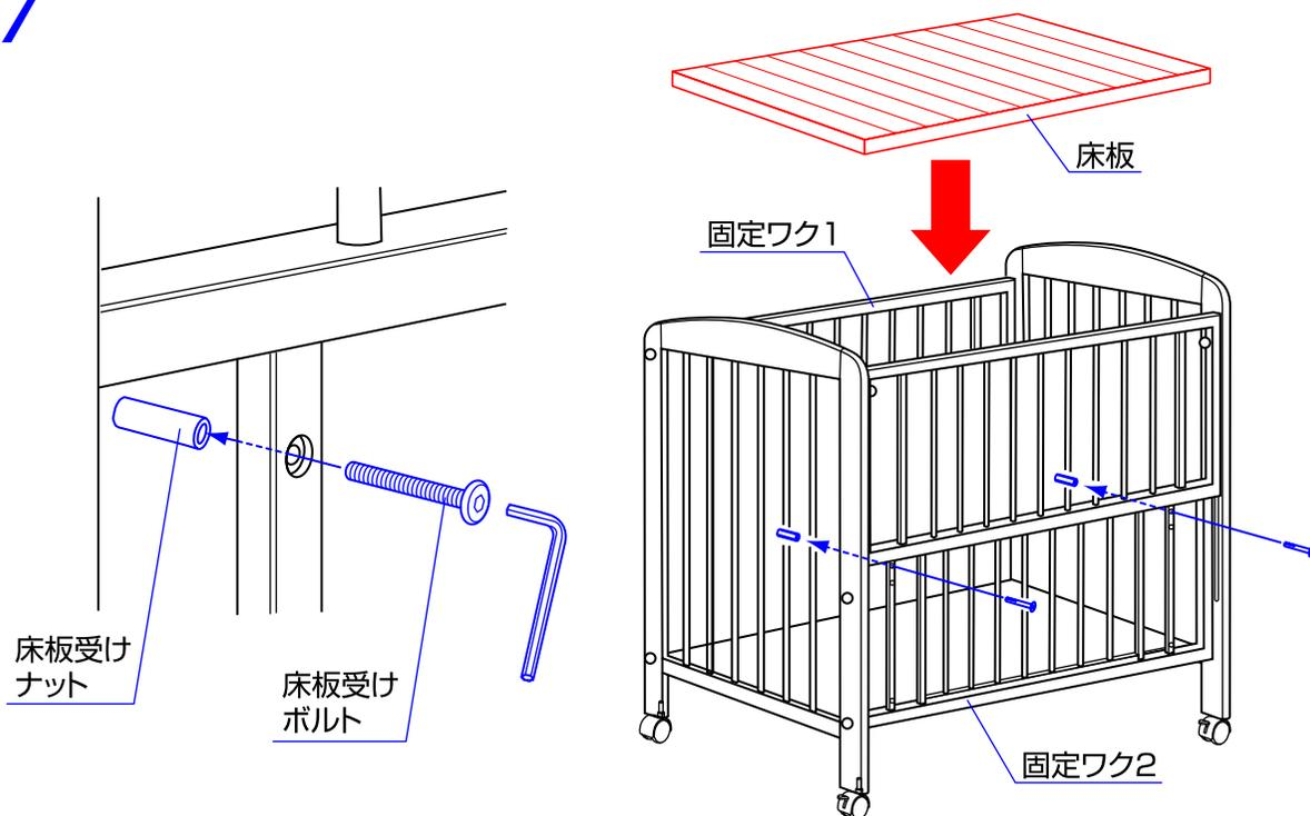
7. 床板受けボルトと床板受けナットを固定ワク1、2に取り付けてください。(3段階調節)
