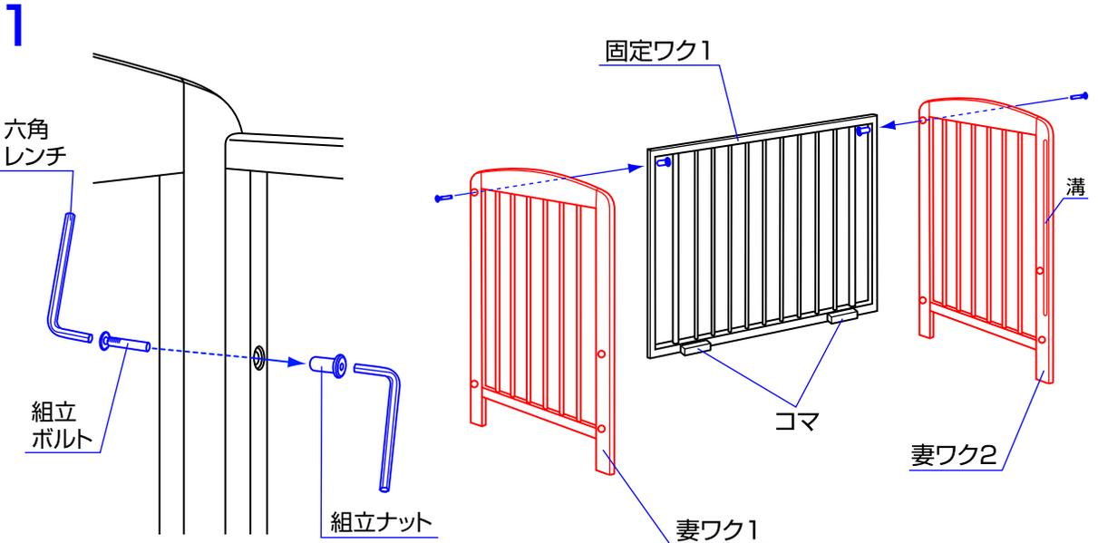
1. 妻ワク1と2を固定ワク1に組立ボルトと組立ナットで固定して下さい。ボルトとナットは六角レンチで締め付けてください。(組立ボルトと組立ナットは先に外してください。)
