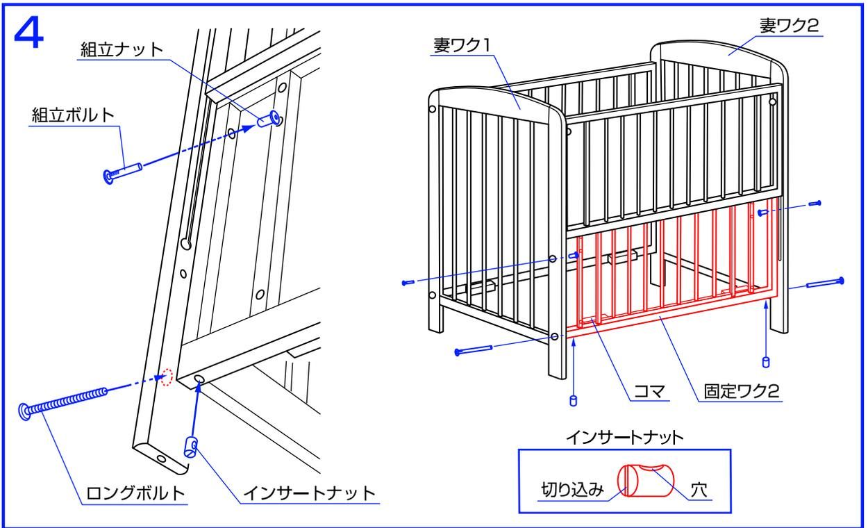
4. 妻ワク1と2と固定ワク2の上側の穴を組立ボルトと組立ナットで固定してください。
