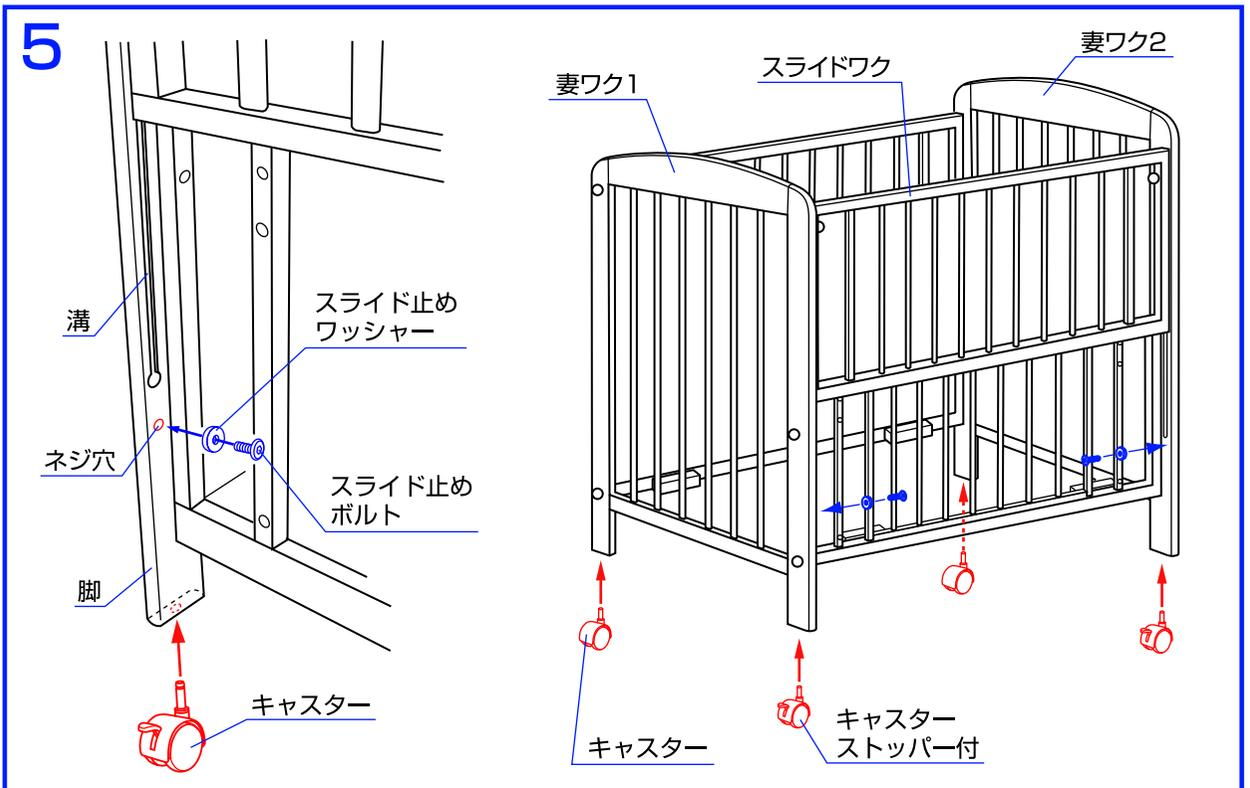
5. 妻ワク1と2の溝の下のネジ穴にスライド止めワッシャーをスライド止めボルトで固定してください。妻ワク1と2の脚の裏側にキャスターを図のように差し込んでください。キャスターはストッパーのある方をスライドワク側に差し込んでください。※ベッドの移動時以外は必ずキャスターのストッパーを上げてロックしてください。
