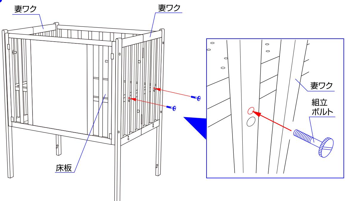
3.床板受けピンの上に床板を載せ、組立ボルトで締めて固定して下さい。(4箇所)
