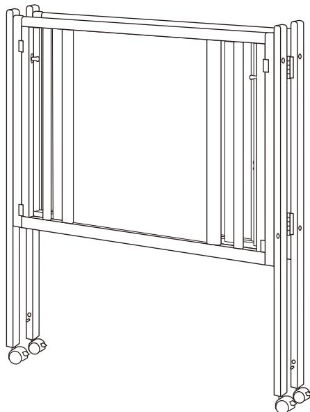
◇本体を折り畳む場合は収納板、床板、床板受けピンを取り外し、妻ワクを固定している組立ボルトを取り外してから折り畳んで下さい。※周りにお子様がいないことを確認してから行って下さい。
