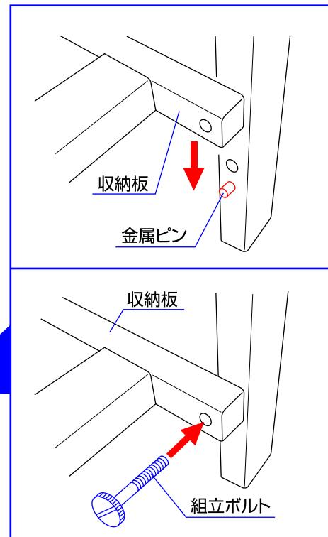
4. 収納板を両側の妻ワクの金属ピンの上に載せ、組立ボルトで固定して下さい。(4箇所)
