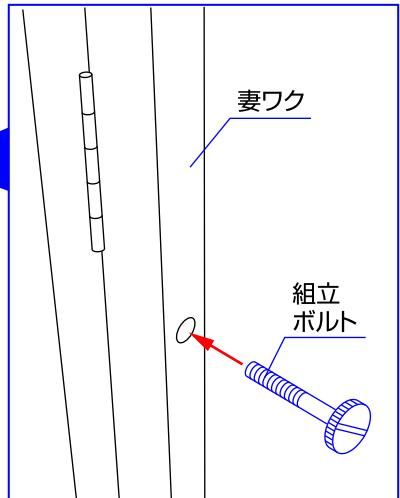
1. 本体を開き、妻ワクの上下を組立ボルトで締めて固定して下さい。反対側の妻ワクも同じように固定して下さい。(4箇所)
