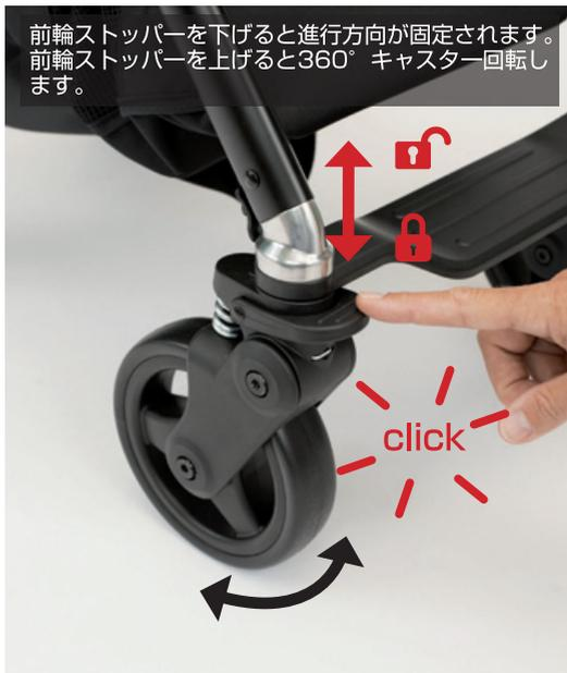
前輪ストッパーを下げると進行方向が固定されます。前輪ストッパーを上げると360° キャスター回転します。
