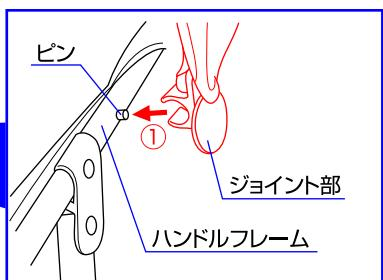
5.①ホロの両側のジョイント部をハンドルフレームのピンの上に取り付けて下さい。※ジョイント部の向きにご注意下さい。
