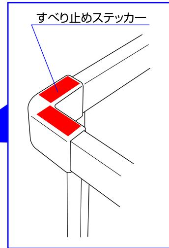
◇ジョイント(直線/角)の裏側にすべり止めステッカーを貼って下さい。
