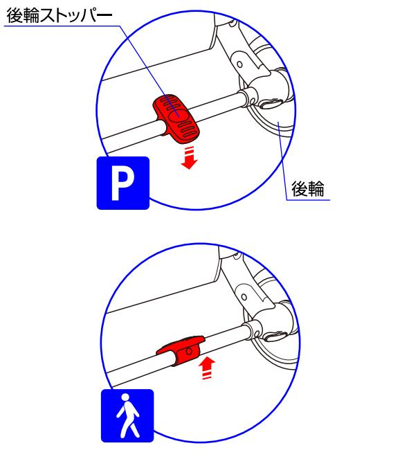
◇後輪ストッパーを下げる時と後輪がロックされます。解除する時は後輪ストッパーを上げて下さい。
