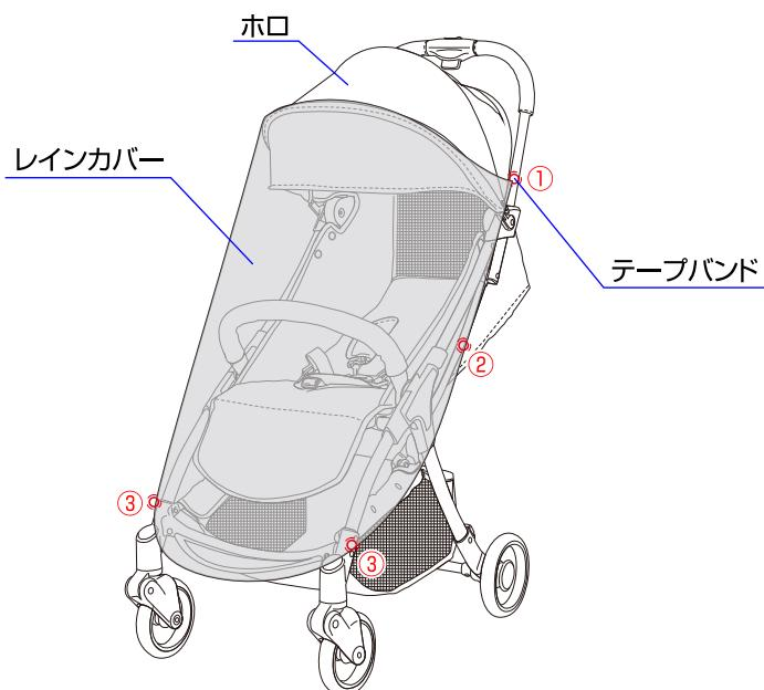
◇ベビーカーのホロを開いて下さい。レインカバーをホロにかぶせて下さい。レインカバーの両側にあるテープバンド①～③(計6箇所)をベビーカーのフレームに巻いて固定して下さい。※レインカバーが確実に固定されていることを必ず確認して下さい。
