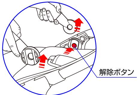
3. ガードの両側を本体の取付部に差し込んで固定して下さい。※ガードが確実に固定されていることを必ず確認して下さい。ガードを取り外す場合は、本体取付部の内側にある解除ボタンを押して下さい。
