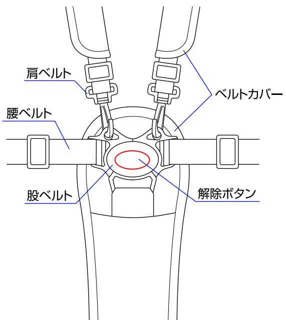
◇シートベルトを取り付ける場合は、肩ベルトを腰ベルトに取り付け、股ベルトに差し込んで下さい。ベルトの長さを調節する場合はアジャスターで調節して下さい。
