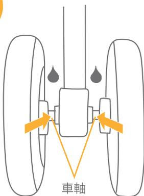
1.前輪・後輪の車輪の動きが悪い場合は、油等を車軸に注して下さい。
