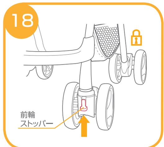
18. 前輪ストッパーを上げると、前輪の進行方向が固定されます。前輪ストッパーを下げると前輪が360°キャスター回転します。
