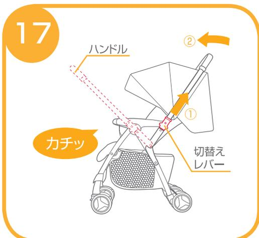
17. 本体を対面式で使用する場合は、①本体の両側にある切替えレバーを引きながら、②ハンドルを反対側に固定するまで回転させて下さい。
