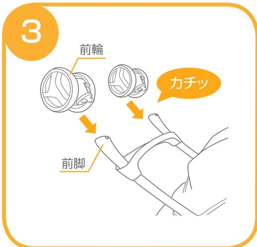
3.前輪を本体両側の前脚にカチッと音が鳴るまで差し込んで下さい。\*前輪が確実に取り付けられていることを必ず確認して下さい。
