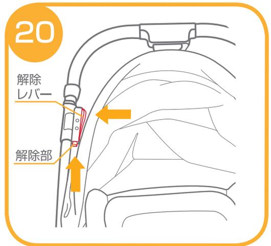
20.ハンドブレーキを解除する場合は、①ハンドブレーキの解除部を押しながら、②解除レバーを押して下さい。
