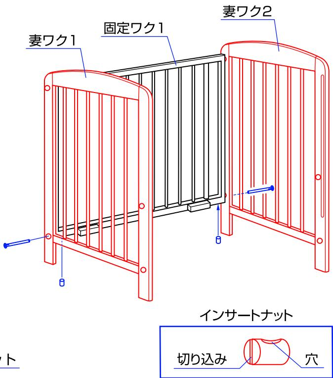
2. 固定ワク1の裏側からインサートナットを差し込み、妻ワク1、2の方向からロングボルトで固定して下さい。
