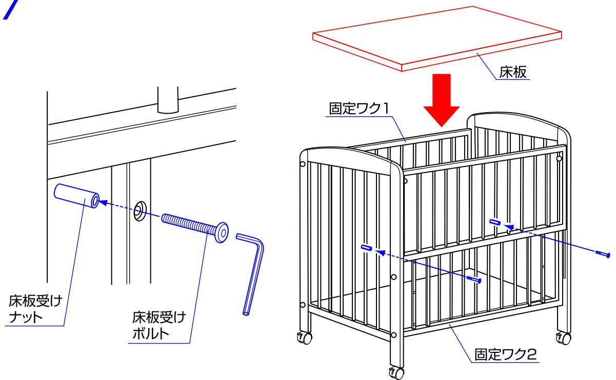
7. 床板受けボルトと床板受けナットを固定ワク1、2に取り付けて下さい。(3段階調節)
