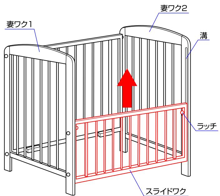
3. スライドワクのガイド部を図のように妻ワク1と2の溝の丸い部分に差し込み、スライドワクを上にスライドさせて下さい。
