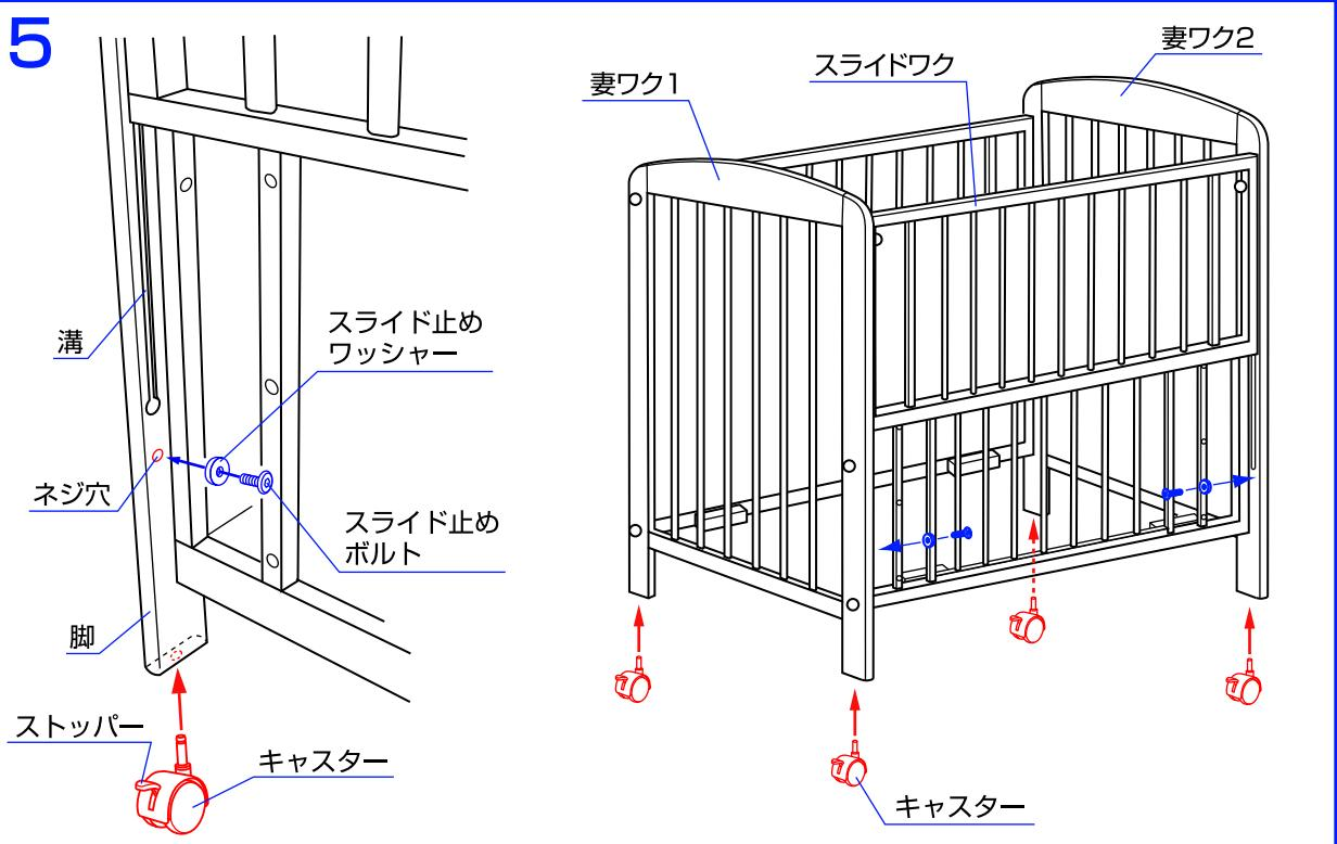
5.妻ワク1と2の溝の下のネジ穴にスライド止めワッシャーをスライド止めボルトで固定して下さい。妻ワク1と2の脚の裏側にキャスターを図のように差し込んで下さい。※ベッドの移動時以外は必ずキャスターのストップバーを下げるロックして下さい。
