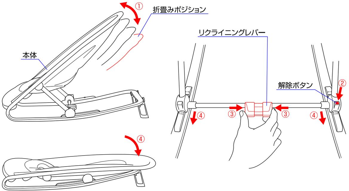
◇①背もたれを折畳みポジションまで倒して下さい。②解除ボタンを押しながら、③リクライニングレバーを握って④リクライニングレバーを後ろにスライドしながら本体を折り畳んで下さい。
