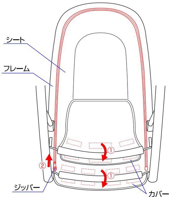
◇①シート後部のカバーを2箇所外して下さい。②ジッパーを開き、シートをフレームから取り外して下さい。
