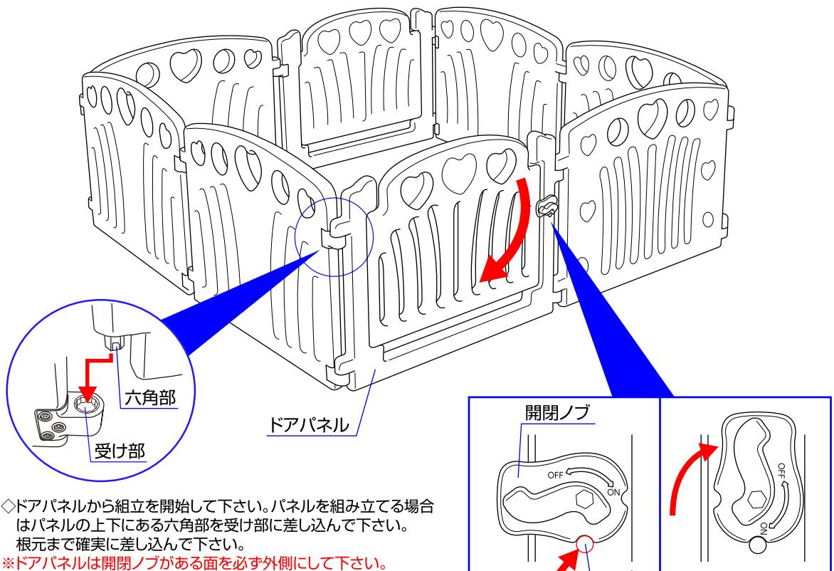
◇ドアパネルから組立を開始して下さい。パネルを組み立てる場合はパネルの上下にある六角部を受け部に差し込んで下さい。
