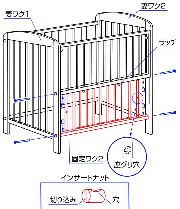
4.固定ワク2の穴にインサートナットを差し込み、妻ワク1と2の方向からロングボルトで固定して下さい。
