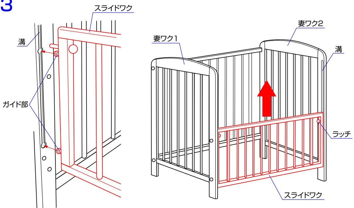
3.スライドワクのガイド部を図のように妻ワク1と2の溝の丸い部分に差し込み、スライドワクを上にスライドさせて下さい。※スライドワクを開閉する時に手足等をはさむ危険性がありますから十分に注意してご使用下下さい。また、保護者の方以外は絶対に操作しないで下さい。
