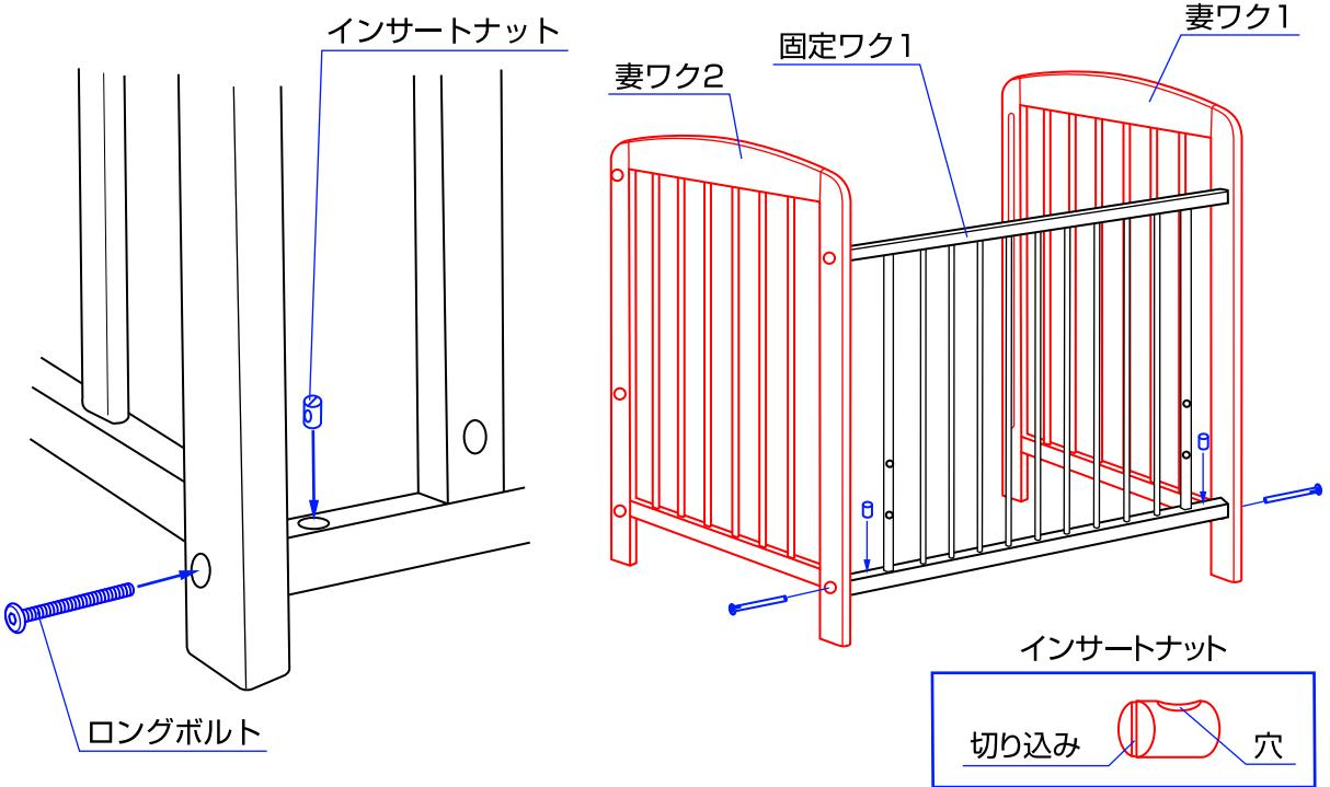
2.固定ワク1にインサートナットを差し込み、妻ワク1、2の方向からロングボルトで固定して下さい。
