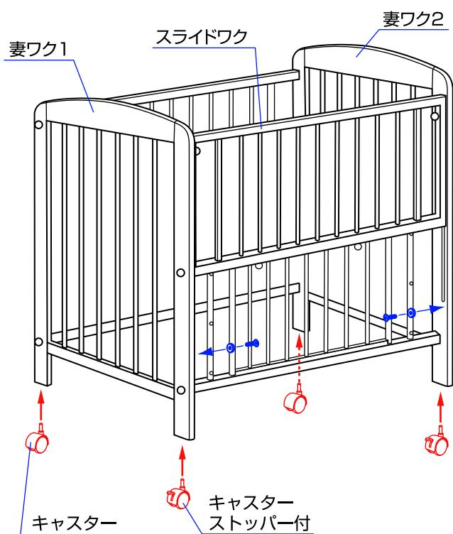
5.妻ワク1と2の溝の下のネジ穴にスライド止めワッシャーをスライド止めボルトで固定して下さい。妻ワク1と2の脚の裏側にキャスターを図のように差し込んで下さい。キャスターはストッパーのある方をスライドワク側に差し込んで下さい。※ベッドの移動時以外は必ずキャスターのストッパーを下げるロックして下さい。
