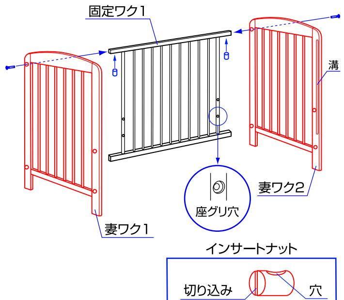
1. 固定ワク1の裏側からインサートナットを差し込み、妻ワク1、2の方向からロングボルトで固定して下さい。
