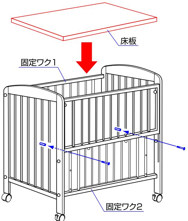
6. 床板受けボルトと床板受けナットを固定ワク1、2に取り付けて下さい。(3段階調節)
