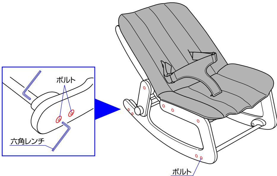
◇定期的に全てのボルトが緩んでいないか確認して下さい。ボルトが緩んでいる場合は、必ず六角レンチで締め付けて下さい。(六角レンチはお子様の手の届かない場所に大切に保管して下さい。)
