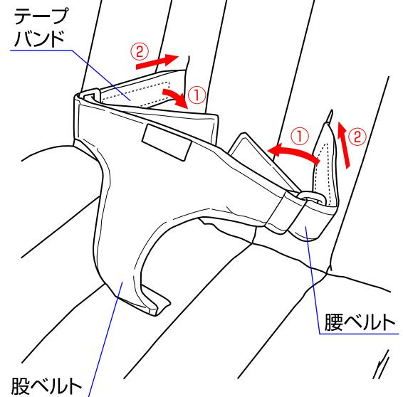
1.腰ベルトのテープバンドを外し、腰ベルトの長さを調節して下さい。※使用中は必ずシートベルトを着用して下さい。
