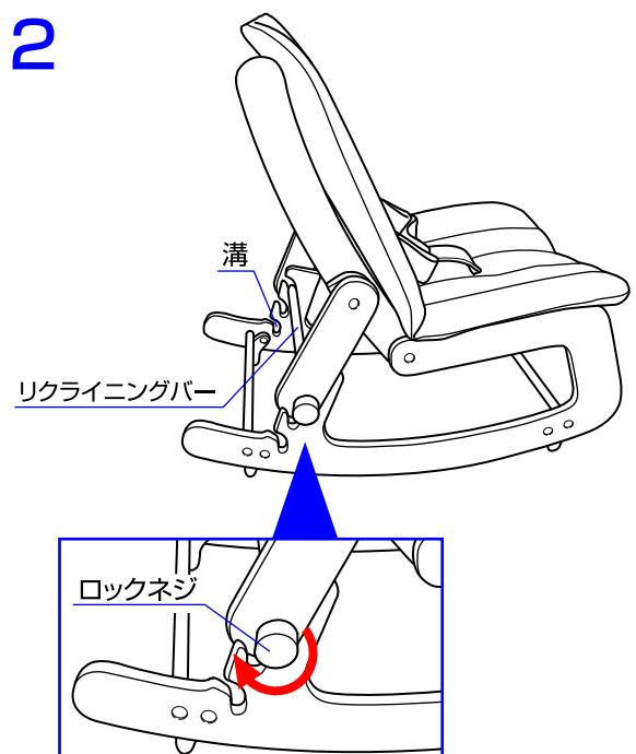
1. ロックネジを図の向きに回して緩めて下さい。
