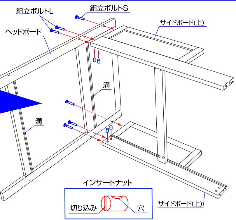
3. サイドボード(上)とヘッドボードを組立ボルトS、Lとインサートナットで取り付けて下さい。組立ボルトは六角レンチで締めて下さい。インサートナットは切り込みを手前にして穴をボルト方向へ向けて下さい。※ヘッドボードは溝のある方を内側にして下さい。
