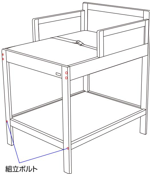
12.おむつ替え台がガタつく場合は、全ての組立ボルトを緩めた後、下側から締め直して下さい。
