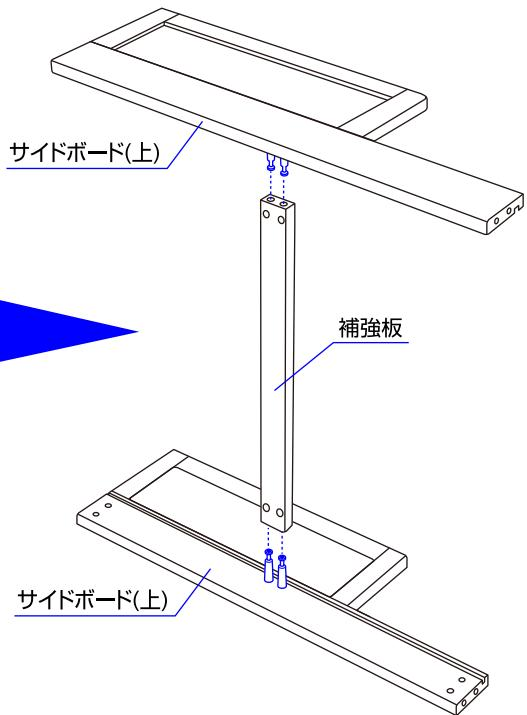
2. ①補強板の穴に回転ナットの+面を手前にして、矢印をボルト方向へ向けて差し込んで下さい。②サイドボード(上)のボルトピンに補強板を差し込んで、③プラスドライバーで回転ナットを矢印方向へ回してロックして下さい。反対側も同じように取り付けて下さい。※補強板が確実に固定されていることを必ず確認して下さい。
