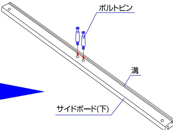
4. サイドボード(下)2本の内側にボルトピンを取り付けて下さい。
