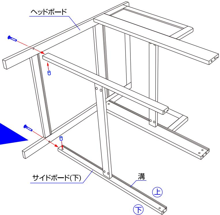
6. サイドボード(下)とヘッドボードを組立ボルトとインサートナットで取り付けて下さい。組立ボルトは六角レンチで締めて下さい。インサートナットは切り込みを手前にして穴をボルト方向へ向けて下さい。※サイドボード(下)の溝の向きに注意して下さい。
