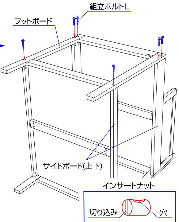
9.サイドボード(上下)と上フットボードを組立ボルトルとインサートナットで取り付けて下さい。組立ボルトルは六角レンチで締めて下さい。インサートナットは切り込みを手前にして穴をボルト方向へ向けて下さい。
