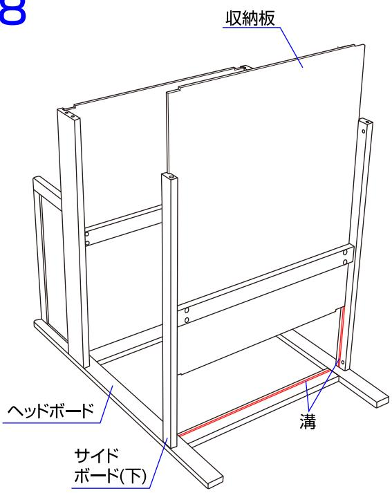
7. サイドボード(上)とヘッドボードの溝に床板を差し込んで下さい。
