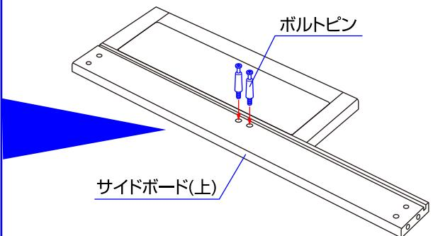
1.サイドボード(上)2枚の内側にボルトピンをプラスドライバーで取り付けて下さい。
