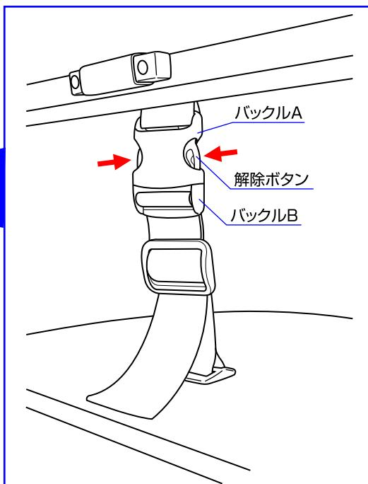
◇股ベルトを取り外す場合は、股ベルトの解除ボタンを押して、股ベルトのバックルAからバックルBを取り外して下さい。
