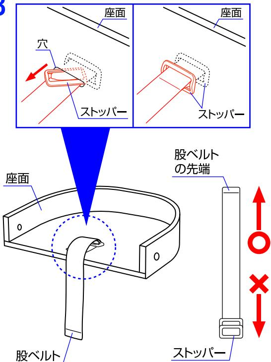
3.座面を反対向きにして下さい。股ベルトのストッパーを図のように座面の穴に通して取り付けて下さい。
