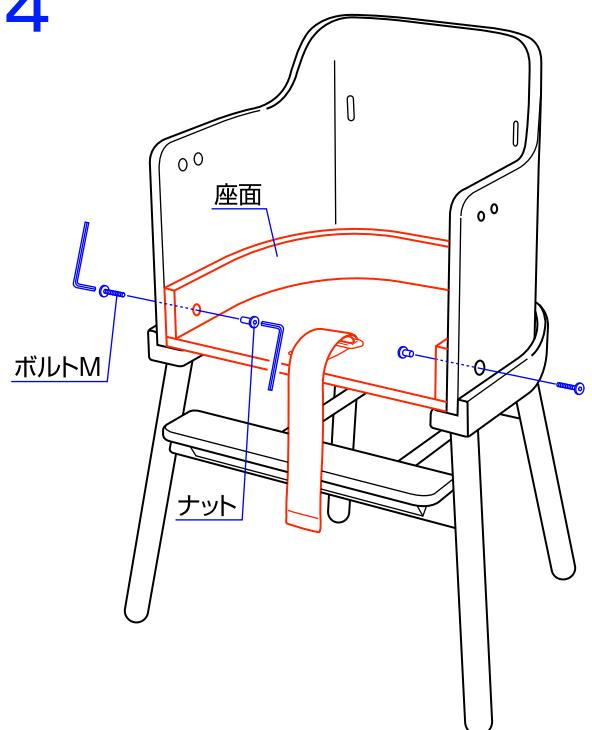
4.座面を本体に設置し、座面の両側からボルトMとナットで固定して下さい。(図の座面は下段の高さになっています。)
