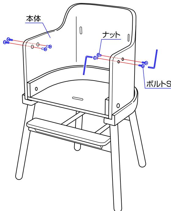
◇テーブルを取り付けない場合は、本体の両側をボルトSとナットで穴を塞いで下さい。
