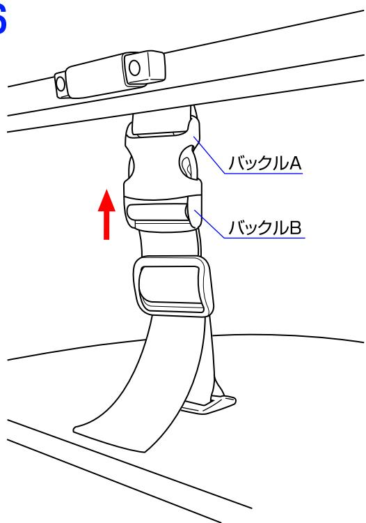
5.バックルAの両側の解除ボタンを押してバックルBを取り外して下さい。緩まないようにバックルBを指で押さえながら、股ベルトをベルトアジャスターに通して下さい。
