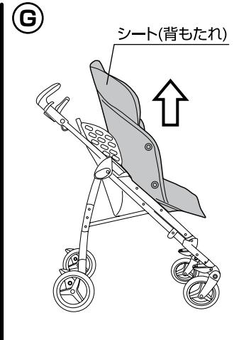
17.(D)シート両側の側面をフレームの固定ピンから取り外して下さい。(E)背もたれの後側から出ている腰ベルトの根元部分のネジを取り外して下さい。(F)シートの座面側を図のように取り外して下さい。(G)シートの背もたれ側から取り外して下さい。※シートを取り付ける時は逆の手順で取り付けて下さい。
