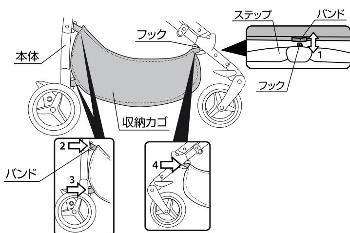
3.ステップのフックと本体のフックに収納カゴのバンドを引っ掛けて下さい。①～④(計7力所)
