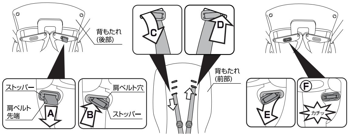
11.肩ベルトの高さを調節する場合は、(A)背もたれ後部から肩ベルトの先端を引っ張りストッパーを取り外し、(B)ストッパーを肩ベルト穴に通して、(C)背もたれの前部から出して下さい。(D)お好みの高さの肩ベルト穴に通し、(E)背もたれの後部から出して下さい。
