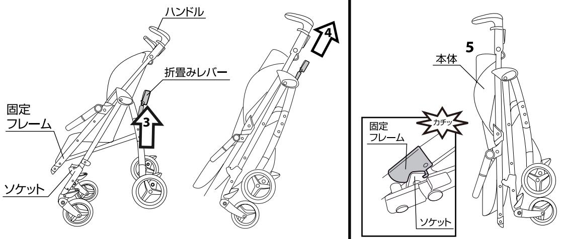
14.ハンドルを少し後側に倒し、両側の固定フレームがソケットから外れたことを確認して下さい。③片手でハンドルを持ったまま、折畳みレバーを引いて④本体を折り畳んで下さい。⑤固定フレームがソケットに確実に取り付けられていることを必ず確認して下さい。
