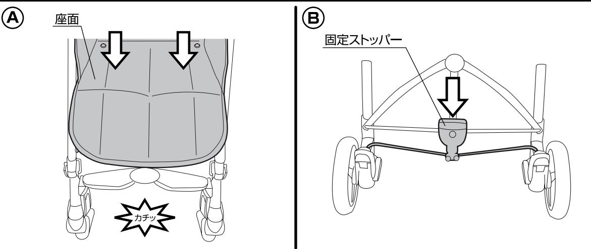
2.(A)座面の両端を上から押し、本体両側の固定フレームがソケットに取り付けられていることを必ず確認して下さい。
