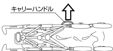
15.(A)折り畳みレバーを持って引いて運ぶことができます。※その場合、両側の前輪ストッパーを上げて前輪の向きを固定して下さい。
