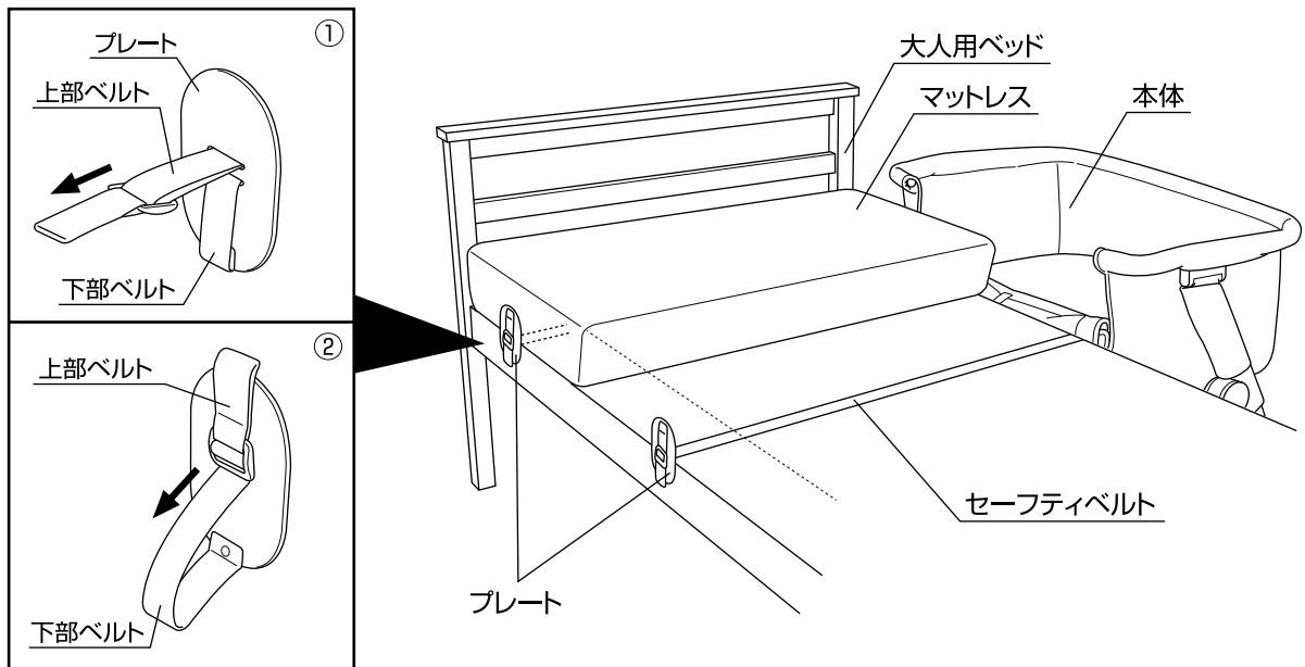
◇セーフティベルトの長さを調節する場合は、「本取扱説明書P7.図2」に載っている方法もありますが、ベルトが緩んだ場合、また長さを微調節する場合は、①プレートを固定しながら上部ベルトを伸ばして下さい。②下部ベルトを伸ばして上部ベルトを図の状態にして固定して下さい。
