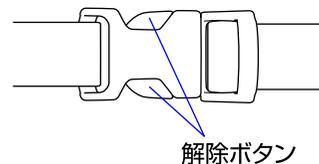
3. 背もたれベルト、座席ベルトをそれぞれ椅子の背もたれ、座席に巻いてバックルで固定して下さい。背もたれベルト、座席ベルトは調節部を引っ張り確実に固定して下さい。バックルを取り外す場合は解除部を押して下さい。
