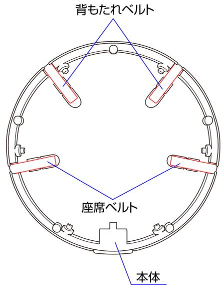
2. 本体の裏側に収納されている背もたれベルト、座席ベルトを出して下さい。※椅子に取り付けない場合は背もたれベルト、座席ベルトは本体裏側に収納して下さい。
