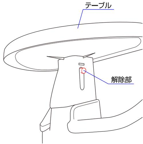
1. テーブルを取り付ける時は本体のガード部に差し込んで下さい。**※テーブルが確実に固定されていることを必ず確認して下さい。**
