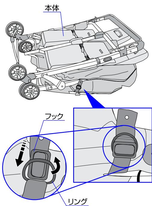
2. 本体両側に付いているフックを回転させながらリングに通して下さい。※本体が確実に折り畳まれていることを必ず確認して下さい。
