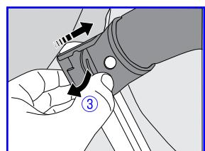
7.①ガードの両側のカバーを開いて、サイドフレームのフックの上から取り付けて、②カバーを閉じて下さい。③ガードを取り外す場合はカバーを開けて取り外して下さい。※カバーの穴からフックが出ていることを必ず確認して下さい。
