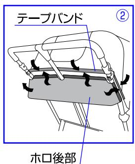
5. ①本体の背もたれ両側に付いているソケットにホロの先端を差し込んで取り付けて下さい。 (4箇所)
