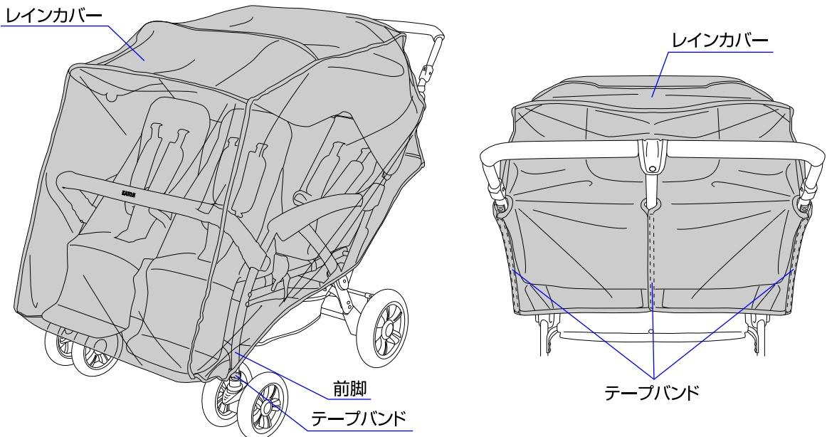
◇ベビーカーのホロを広げた状態でレインカバーをかぶせて下さい。レインカバーのテープバンドを前脚に巻いて固定して下さい。レインカバーの後部をハンドルを挟むようにしてテープバンドで固定して下さい。
