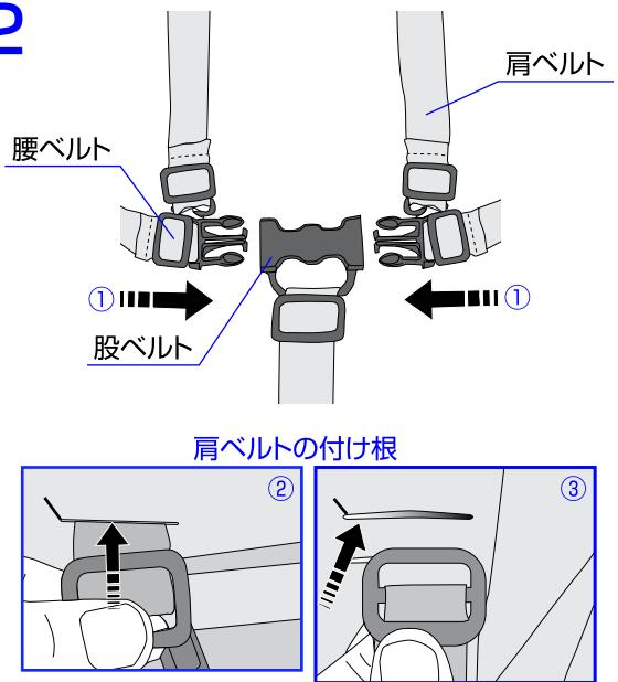
1. ①股ベルトから腰ベルトを取り外す場合は解除ボタンを押して下さい。②ベルトの長さを調節する時はアジャスターで調節して下さい。
