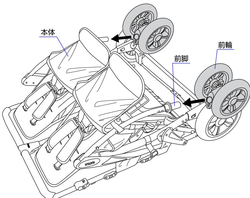
2. 本体両側の前脚に前輪を差し込んで取り付けて下さい。※前輪が確実に取り付いているか必ず確認して下さい。
