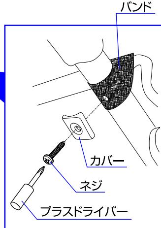
6.ハンドルフレームに付いているカバーのネジをプラスドライバーで取り外して下さい。
