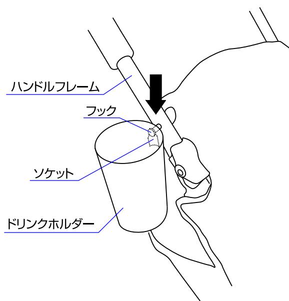
◇ドリンクホルダーを取り付ける場合は、ドリンクホルダーのソケットをハンドルフレームのフックに上から押し込み取り付けて下さい。※ドリンクホルダーが確実に取り付けられているか必ず確認して下さい。
