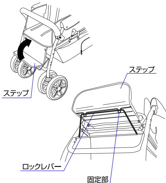
◇ステップの高さを調節する場合は、ステップを上げて、ロックレバーを固定部の下に固定して下さい。
