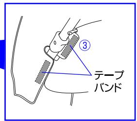
4.本体の両側にあるソケットにホロ(前席)の先端を差し込んで下さい。※ホロが確実に取り付けられていることを必ず確認して下さい。
