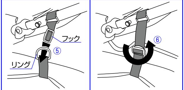
◇①ホロ(3箇所)を折り畳んで下さい。ホロ(前席)は前に折り畳んで下さい。②本体片側にある解除ボタンを押しながら、③両側の折畳みレバーを引いて下さい。④ハンドルを前に倒して本体を折り畳んで下さい。⑤本体両側にあるフックをリングに通し、⑥フックがリングから外れないことを確認して下さい。
