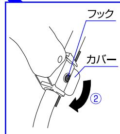
6.①ガードのカバーを開けて、サイドフレームのフックの上からガードを取り付け、②カバーを閉じてカバーの穴からフックを出して下さい。※ガードが確実に取り付けられているか必ず確認して下さい。
