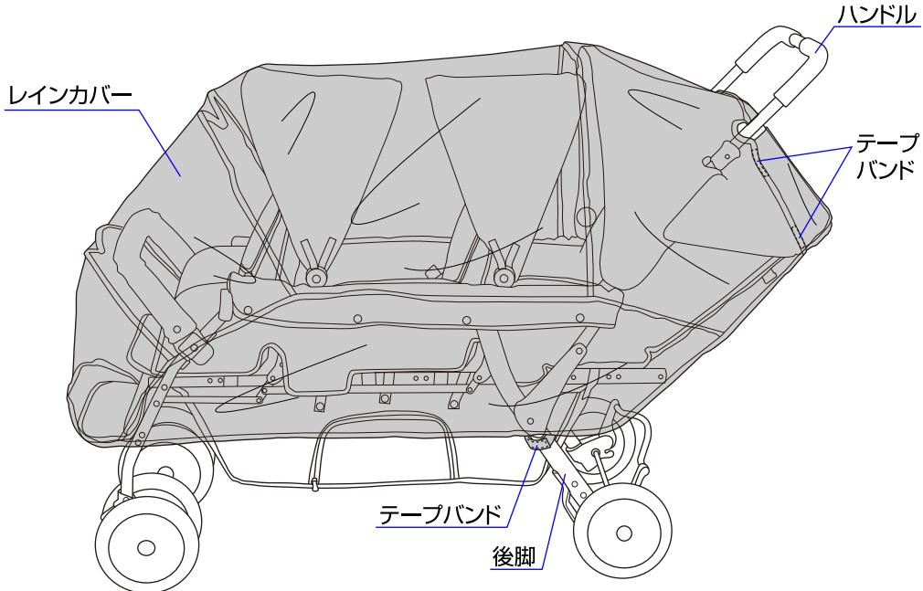
◇ベビーカーのホロを広げた状態でレインカバーをかぶせて下さい。レインカバーの両側にあるテープバンドを後脚フレームに巻いて固定して下さい。レインカバーの後部をハンドルを挟むようにしてテープバンドで固定して下さい。
