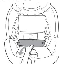
09 受けバックルを、座面のカバーの切り込み（通し穴）に押し込んで、反対側に抜き出します。
