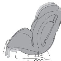
シェルの▽の印を、ベースの赤い△の位置のいずれかに合わせます。
