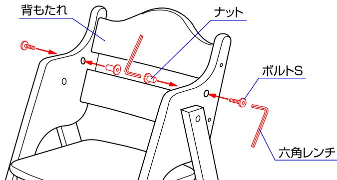
◇テーブルを取り付けない時は図のようにナットとボルトSを六角レンチで締めて穴をふさいで下さい。
