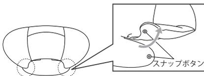
バックルを外し、座面側(下)のソフトパッドを取り外します。
