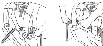
溝から滑り込ませるように自動車腰ベルトを後ろ向きベルトスロットに差し入れます。
