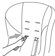
14 肩ベルトパッドを、本体シェルの後ろ側から、確認した適切な高さの肩ベルト穴に差し入れて通します。この際に、次のポイントにご注意ください。
