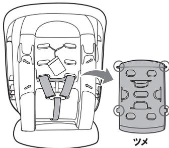
バックカバーを外したら、本体シェル背面にベルトプレートが見えていることを確認してください。
