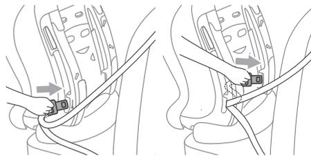
自動車ベルトタングを片方の前向きベルトパスから通して、
