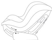
本体シェルの青いダイヤモンド型のマークと、本体ベースの青いダイヤモンド型のマークが一致するようにリクライニングを調節します。
