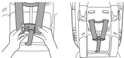
ベルトプレートの溝から差し入れて取り付けます。
