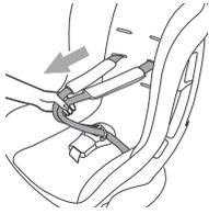
バックルを留めて、左右の肩ベルトを引いても肩ベルトが抜けないことを確認します。
