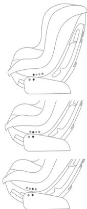
本体シェルにある3箇所の赤い丸型のマークのいずれかと、本体ベースの赤い丸型のマークが一致するようにリクライニングを調節します。
