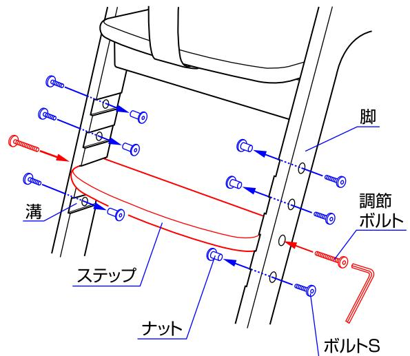
1.ステップの高さを調節する場合は、両側に付いている調節ボルトを六角レンチで取り外し、脚の溝からステップを取り外して下さい。
