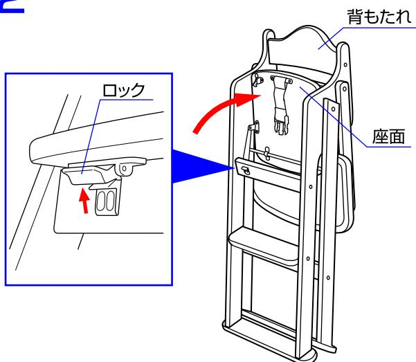
1.股ベルトの解除ボタンを押して取り外し、テーブルを後ろに回して下さい。
