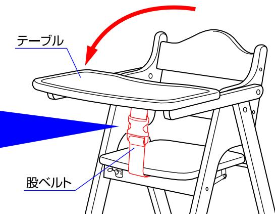
3. テーブルを前に回して、股ベルトを取り付けて下さい。(テーブルを使用する時は必ず股ベルトを取り付けて下さい。)※36ヶ月未満の乳幼児が使用する場合はテーブルを必ず使用して下さい。
