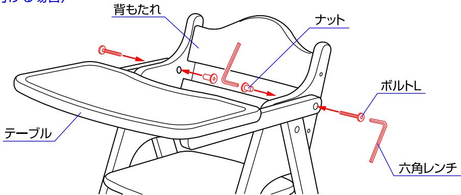
◇テーブルを取り付ける時は図のようにナットとボルトLを六角レンチで締めて取り付けて下さい。
