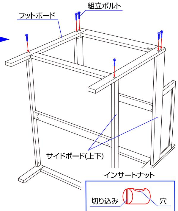
9. サイドボード(上下)と上フットボードを組立ボルトとインサートナットで取り付けて下さい。インサートナットは切り込みを手前にして穴をボルト方向へ向けて下さい。
