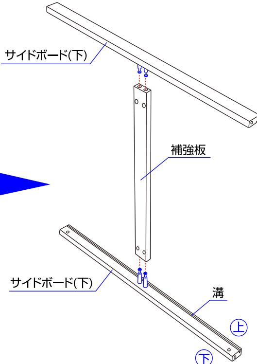
5. ①補強板の穴に回転ナットの+面を手前にして、矢印をボルト方向へ向けて差し込んで下さい。②サイドボード(下)のボルトピンに補強板を差し込んで、③プラスドライバーで回転ナットを矢印方向へ回してロックして下さい。反対側のサイドボード(下)も溝の向きを合わせて同じように取り付けて下さい。※補強板が確実に固定されていることを必ず確認して下さい。
