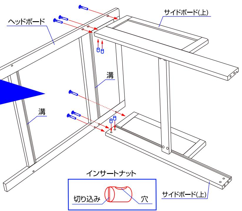
3. サイドボード(上)とヘッドボードを組立ボルトとインサートナットで取り付けて下さい。インサートナットは切り込みを手前にして穴をボルト方向へ向けて下さい。※ヘッドボードは溝のある方を内側にして下さい。
