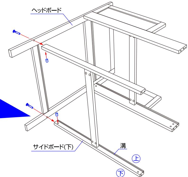
6. サイドボード(下)とヘッドボードを組立ボルトとインサートナットで取り付けて下さい。インサートナットは切り込みを手前にして穴をボルト方向へ向けて下さい。※サイドボード(下)の溝の向きに注意して下さい。
