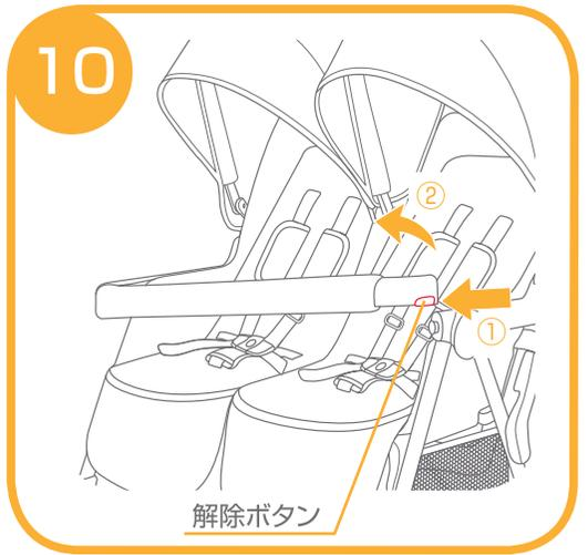
10.ガードを取り外す場合は、①ガードの両側に付いている解除ボタンを押して、②取り外して下さい。
