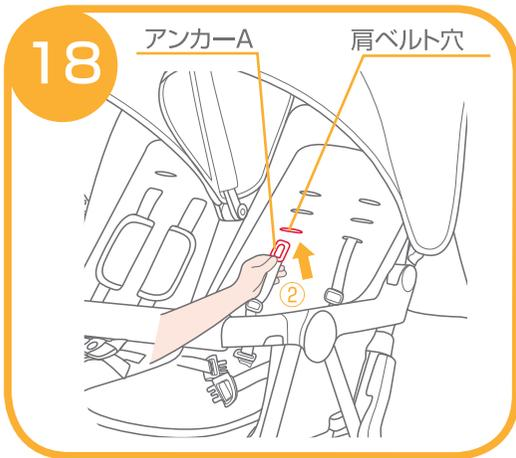
18. ②背もたれの表側からアンカー-Aを図の向きにして好みの高さの肩ベルト穴に差し込んで下さい。※肩ベルトの高さは必ず左右同じ高さにして下さい。
