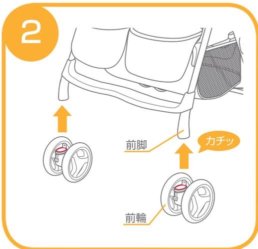
2.前輪を本体両側の前脚にカチッと音が鳴るまで差し込んで下さい。※前輪が確実に取付けられていることを必ず確認して下さい。
