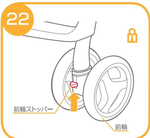
22. 前輪ストッパーを上げると、前輪の進行方向が固定されます。前輪ストッパーを下げると前輪が360°キャスター回転します。
