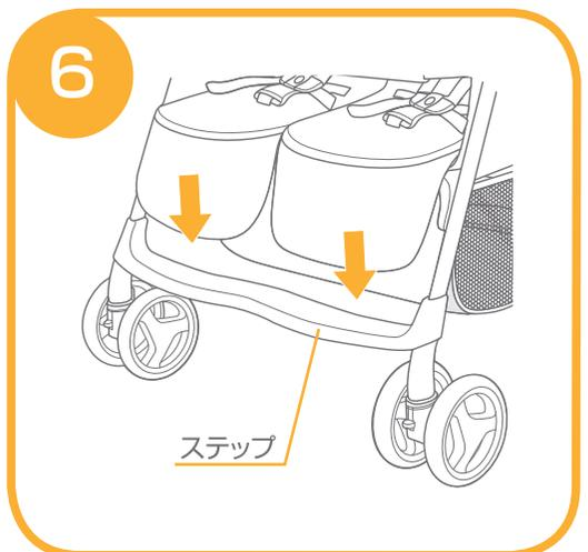
6.ステップを下げて確実に固定して下さい。
