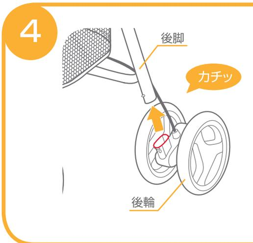
4.後輪を本体両側の後脚にカチッと音が鳴るまで差し込んで下さい。後輪ストッパーがある後輪は図のように右側に取付けて下さい。後輪のチューブを本体フレームの下側からフックに取り付けて下さい。※後輪が確実に取付けられていることを必ず確認して下さい。
