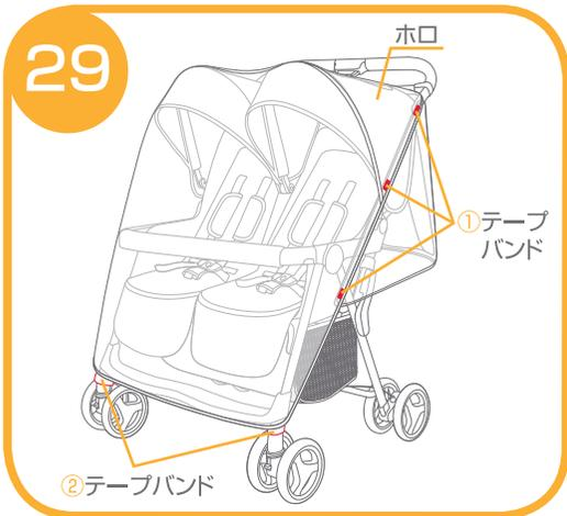
29.レインカバーを取り付ける場合は、本体のホロを開いた状態で行って下さい。ホロにレインカバーをかぶせて、①両側にあるテープバンド(計6箇所)を固定して下さい。②両側の前脚にテープバンドを巻いて固定して下さい。
