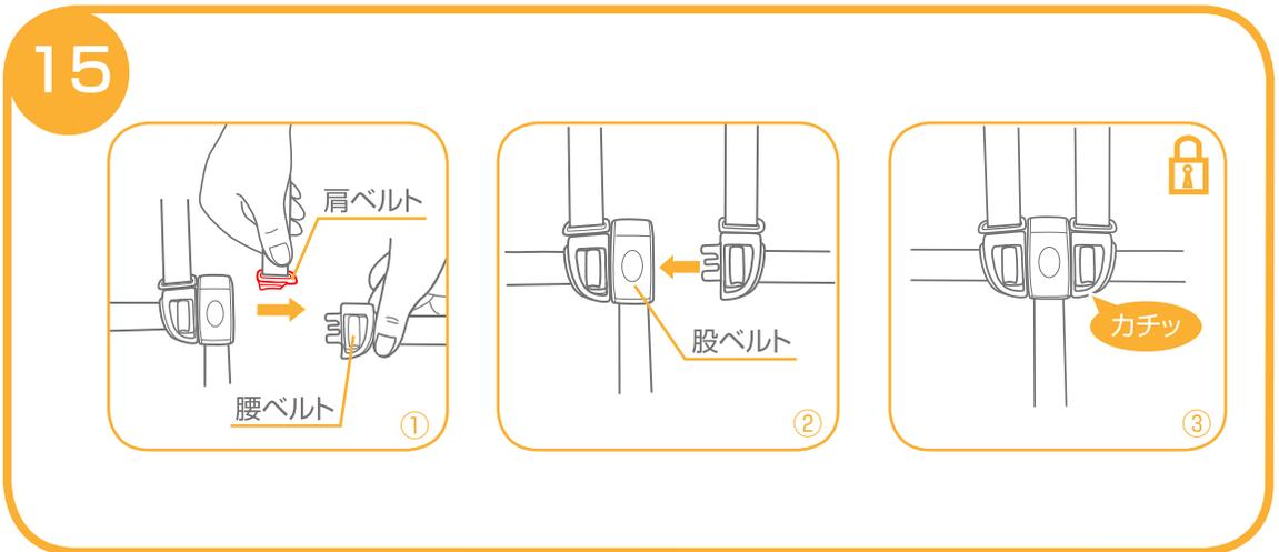
15.シートベルトを取り付ける場合は、①肩ベルトを腰ベルトに通し、②股ベルトに差し込んで下さい。
