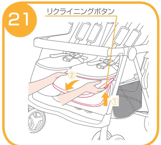
21. 座面を下げる場合は、①座面の両側にあるリクライニングボタンを押しながら、②座面を下げて下さい。
