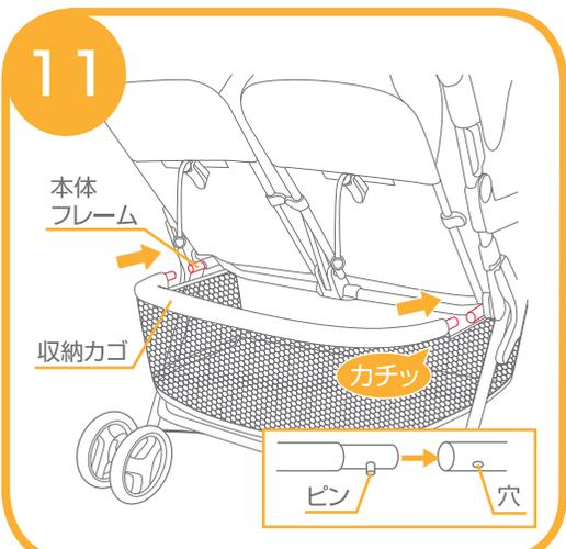
11.収納カゴのフレームのピンを押しながら、本体のフレームに差し込み、穴からピンを出して下さい。
