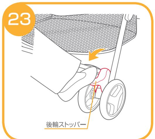
23. 後輪に付いている後輪のストッパーを下げると後輪がロックされます。※後輪ストッパーは自動車のような安全な構造にはなっていませんので過信しないで下さい。
