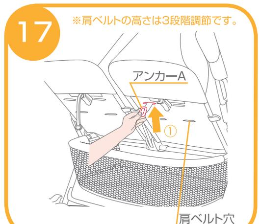
17.肩ベルトの高さを調節する時は、①背もたれの後部からアンカー-Aを図の向きにして肩ベルト穴に差し込んで下さい。
