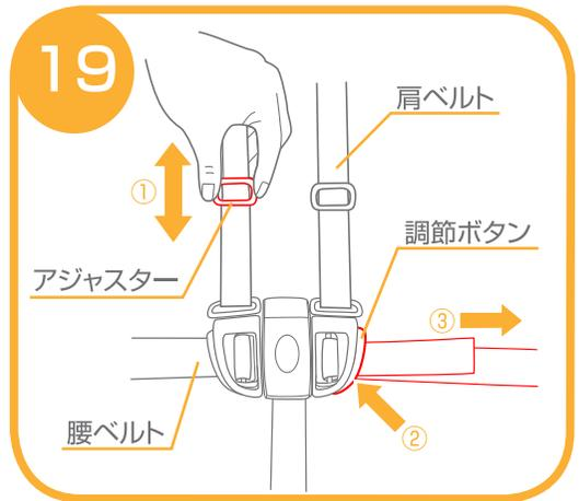
19. ①肩ベルトアジャスターで長さを調節できます。腰ベルトの長さを調節する時は、②調節ボタンを押しながら、③腰ベルトを引っ張り調節して下さい。
