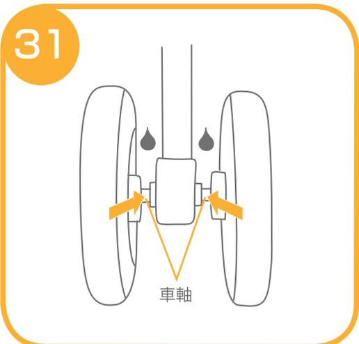
31.前輪・後輪の車輪の動きが悪い場合は、油等を車軸に注して下さい。
