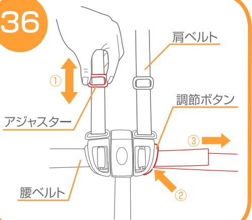
36. ①肩ベルトアジャスターで長さを調節できます。腰ベルトの長さを調節する時は、②調節ボタンを押しながら、③腰ベルトを引っ張り調節して下さい。
