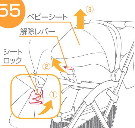
55.ベビーシートを取り外す場合は、①シートロックを引っ掛け、②ベビーシートの解除レバーを上げて、③ベビーシートを取り外して下さい。
