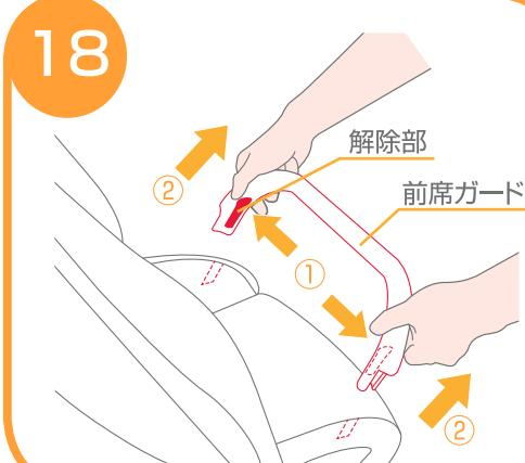
18. 前席ガードを取り外す場合は、①ガードの内側にある解除部を押して②取り外して下さい。
