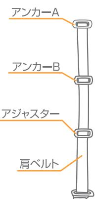
39. 大きなお子様には、肩ベルトのアンカーAを一番上の肩ベルト穴に通して背もたれの後部から出して下さい。小さなお子様には、肩ベルトのアンカーBを一番下の肩ベルト穴に通して背もたれの後部から出して下さい。
