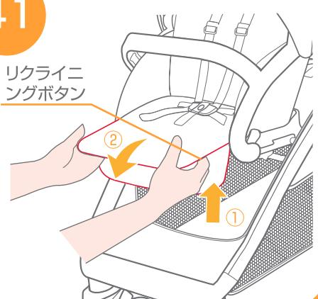
41. 座面を下げる場合は、①座面の両側にあるリクライニングボタンを押しながら、②座面を下げて下さい。
