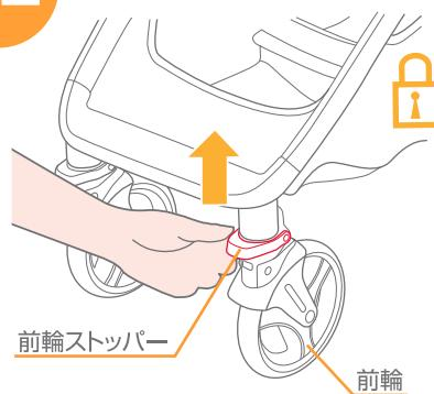
42. 前輪ストッパーを上げると、前輪の進行方向が固定されます。前輪ストッパーを下げると前輪が360°キャスター回転します。
