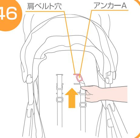
46. 背もたれの表側からアンカーAを図の向きにして好みの高さの肩ベルト穴に差し込んで下さい。※肩ベルトの高さは必ず左右同じ高さにして下さい。
