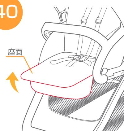
40. 座面の角度をあげる場合は、座面を持ち上げて下さい。(2段階調節)
