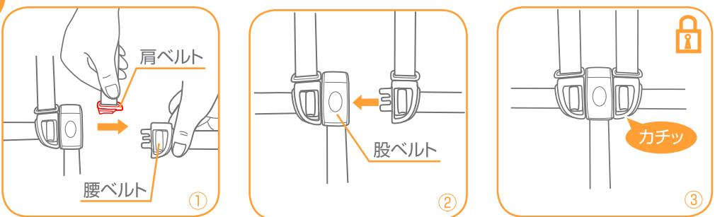
38. シートベルトを取り付ける場合は、①肩ベルトを腰ベルトに通し、②股ベルトに差し込んで下さい。
