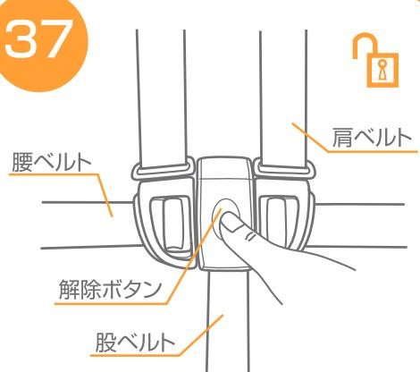
37. シートベルトを取り外す場合は、股ベルトの解除ボタンを押して、腰ベルトと肩ベルトを取り外して下さい。
