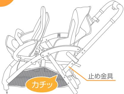
3. 止め金具がカチッと固定し、本体が確実に固定されていることを必ず確認して下さい。
