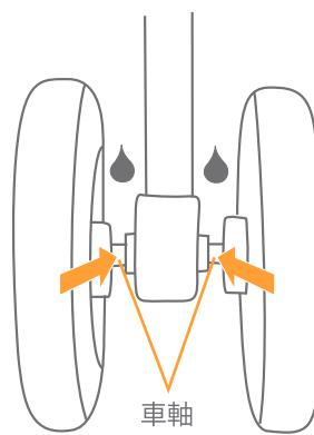
56.前輪・後輪の車輪の動きが悪い場合は、油等を車軸に注して下さい。
