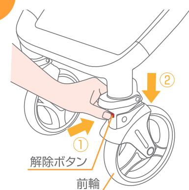
6. 前輪を取り外す場合は、前輪の解除ボタンを押して取り外して下さい。(①→②)
