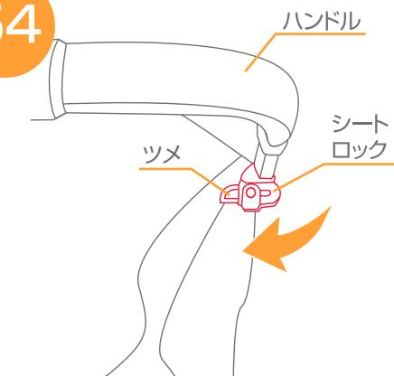
54.ハンドルに付いているシートロックを回してツメを出して下さい。※ベビーシートを取り付ける場合は必ずシートロックのツメを出して下さい。
