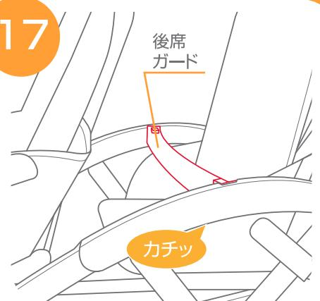
17. 本体を使用する場合は、ガードが確実に固定されていることを必ず確認して下さい。
