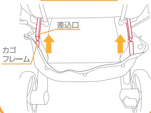
12.差込口のピンを押しながらカゴフレームを差し込んで下さい。カゴフレームの穴からピンが出ていることを確認して下さい。
