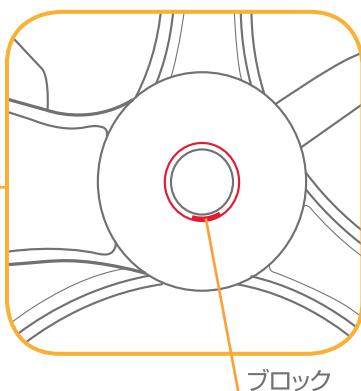
7. 後輪シャフトの溝を後輪のブロックに合わせて差し込んで下さい。
