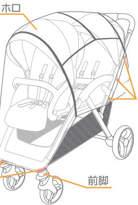
51.レインカバーを取り付ける場合は、本体のホロを開き、ホロにレインカバーをかぶせて、①両側にあるテープバンド(計6箇所)を固定して下さい。②両側の前脚にテープバンドを巻いて固定して下さい。
