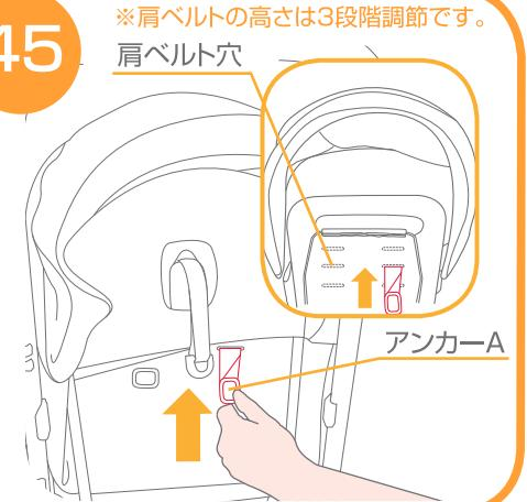
45. 肩ベルトの高さを調節する時は、背もたれの後部からアンカーAを図の向きにして肩ベルト穴に差し込んで下さい。
