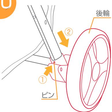
10.後輪を取り外す場合は、後輪から出ているピンを押して取り外して下さい。(①→②)
