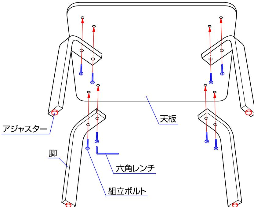
◇天板に脚(計4個)を組立ボルトで取り付けて下さい。組立ボルトは六角レンチで確実に締め付けて下さい。※製品の性質上、がたつく場合がありますので、その場合には脚の裏側に付いているアジャスターを回して調節して下さい。
