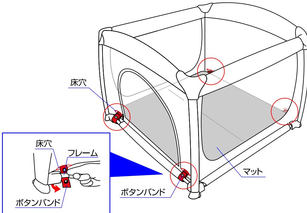
9.マットの四方に付いているボタンバンドを本体の四方にある床穴に通してフレームに固定して下さい。
