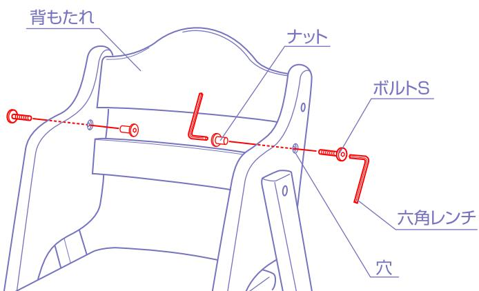
2. テーブルを取り付けない時は図のようにナットとボルトSを六角レンチで締めて穴をふさいで下さい。
