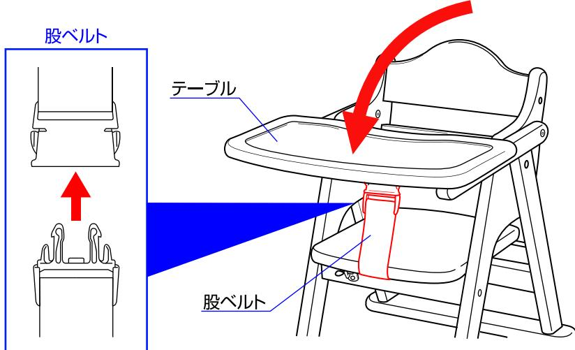
3. テーブルを前に回して、股ベルトを取り付けて下さい。※テーブルを使用する時は必ず股ベルトを取り付けて下さい。
