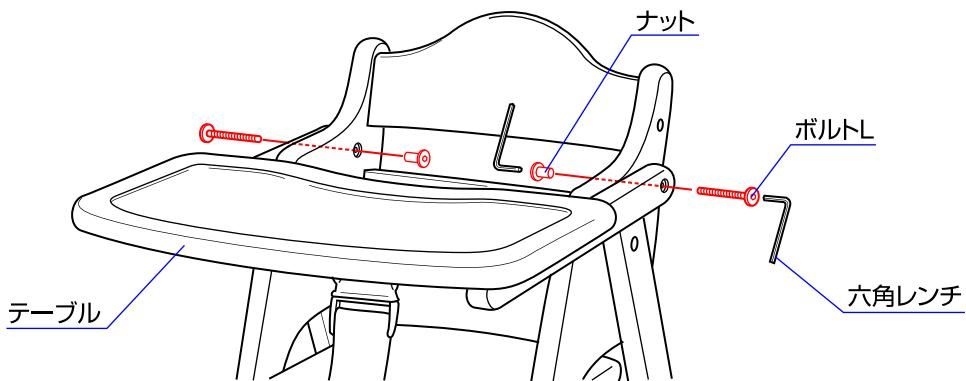
◇テーブルを取り付ける時は図のようにナットとボルトLを六角レンチで締めて取り付けて下さい。
