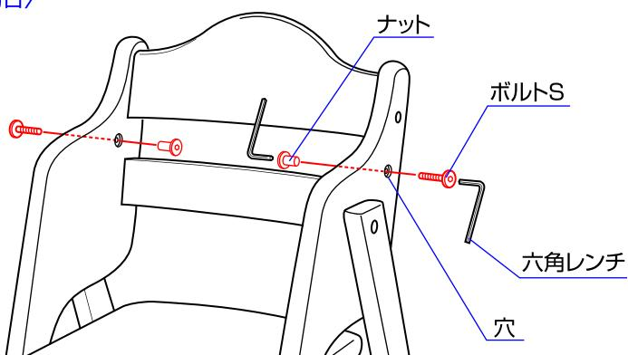
◇テーブルを取り付けない時は図のようにナットとボルトSを六角レンチで締めて両側の穴をふさいで下さい。
